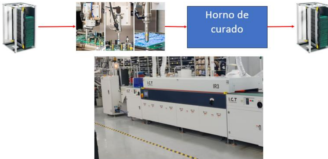
Figura 21 Proceso del área de conformal. (Fotografías tomada de la empresa, Elaboración propia).
