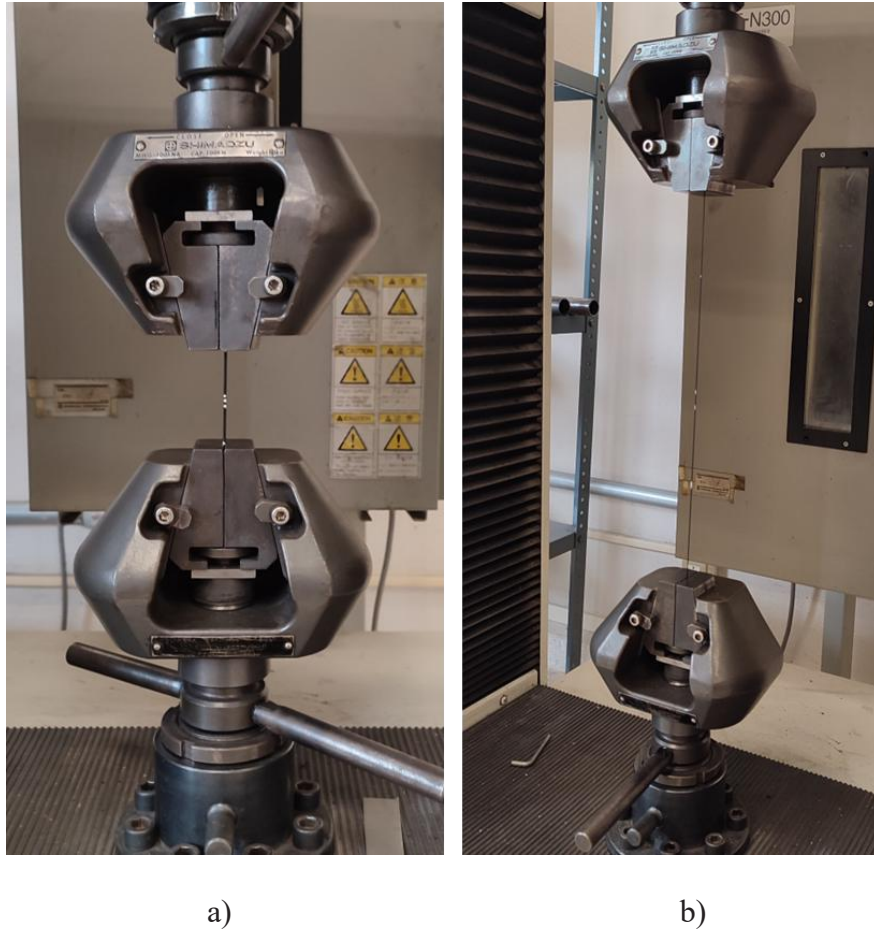
Figura 3.4. Ejemplo de un ensayo de tensión realizado a una muestra de filamento TPU: a) al comenzar el ensayo; y b) a punto de terminar el ensayo.
