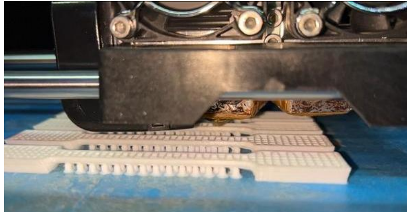
Figura 3.5. Visualización de estructuras de soporte en la fabricación de probetas.
