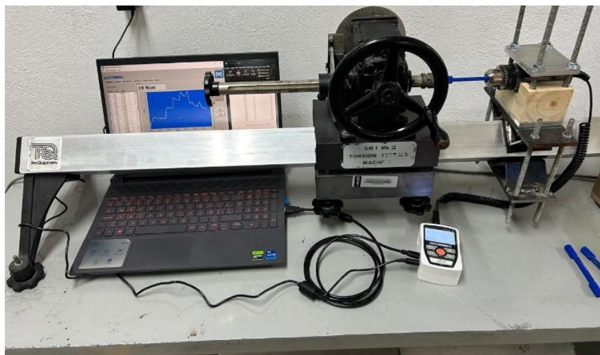
Figura 3.9. Sistema de pruebas de torsión utilizado para las probetas FFF.
