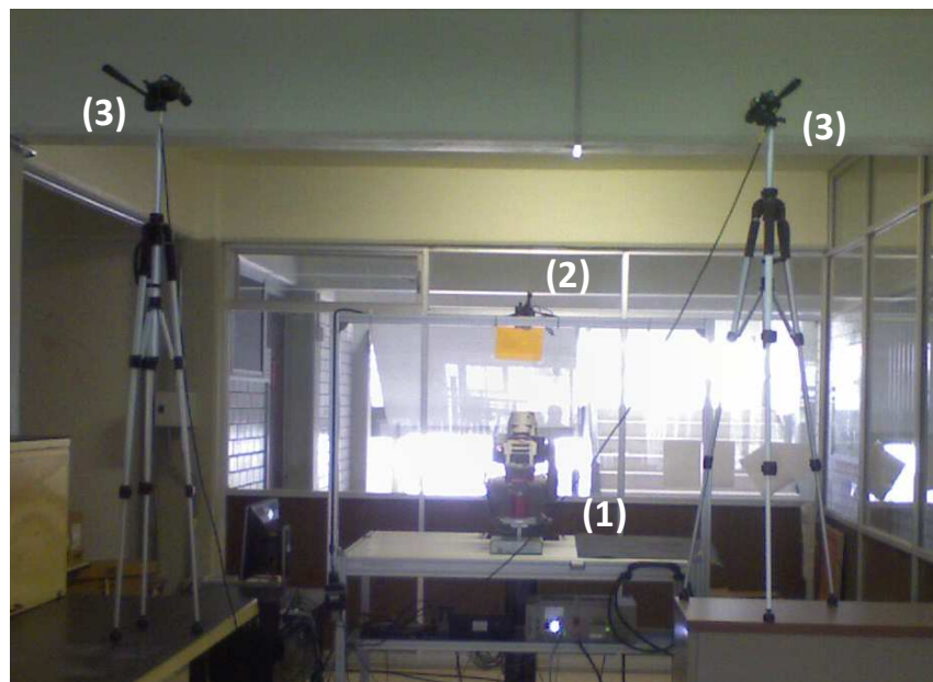
Figura 4.3: Plataforma de pruebas experimentales utilizada para validar los resultados obtenidos. (1) Robot Motoman HP3, (2) Unidad pan-tilt donde está montado el láser, (3) Cámaras uEye montadas en tripies.
