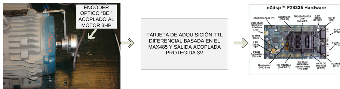
Figura 3.7. Diagrama simplificado de la adquisición de señales del encoder de cuadratura.
