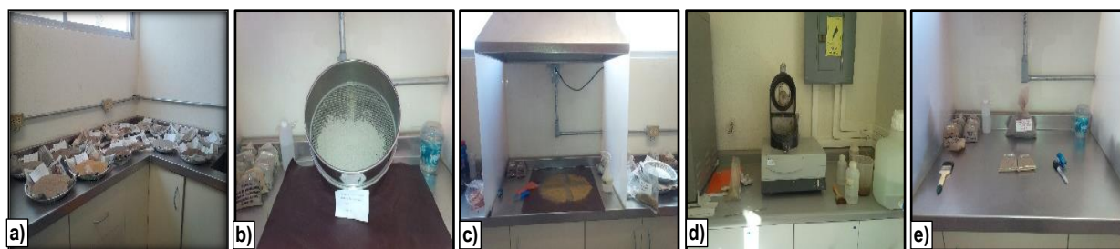
Figura 20. Procesamiento de muestras; a) Secado de muestras, b) Tamizado, c) Cuarteo, d) pulverizado y e) Identificación.
