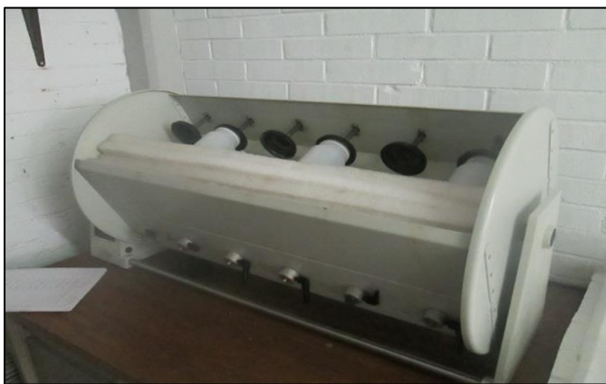
Agitador orbital (Heidolph Reax 20/12; número de serie 050001151. Fabricado por Schott Mexicana).
