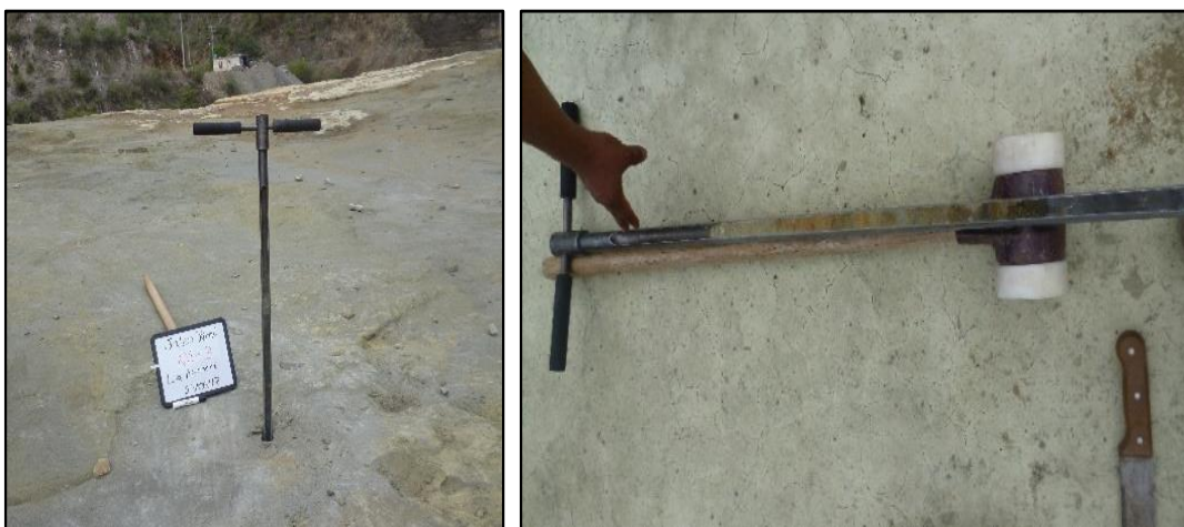
Figura 14.- Nucleador de acero inoxidable utilizado para el muestreo de la zona oxidada del AMWD4.
