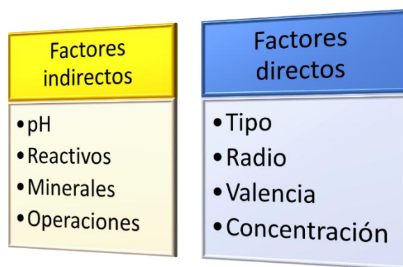
Figura 4: Factores que influyen en la función de los iones metálicos en la flotación.
