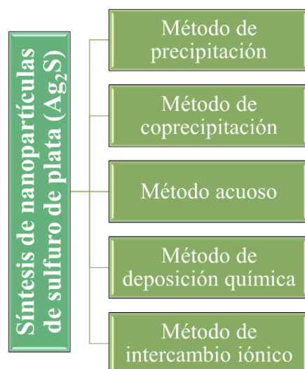
Figura 19: Métodos de síntesis para la obtención de nanopartículas de \text{Ag}_2\text{S} .
