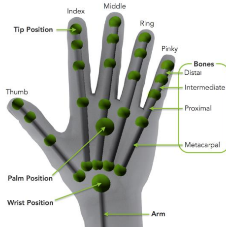
Figura 3.1. Puntos de rastreo del Leap Motion [67].
