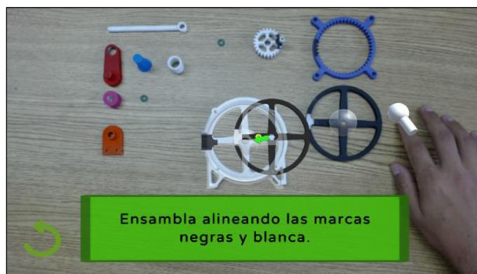
Figura 5.11. Realidad aumentada de asistencia para el ensamble del transformador de movimiento lineal.
