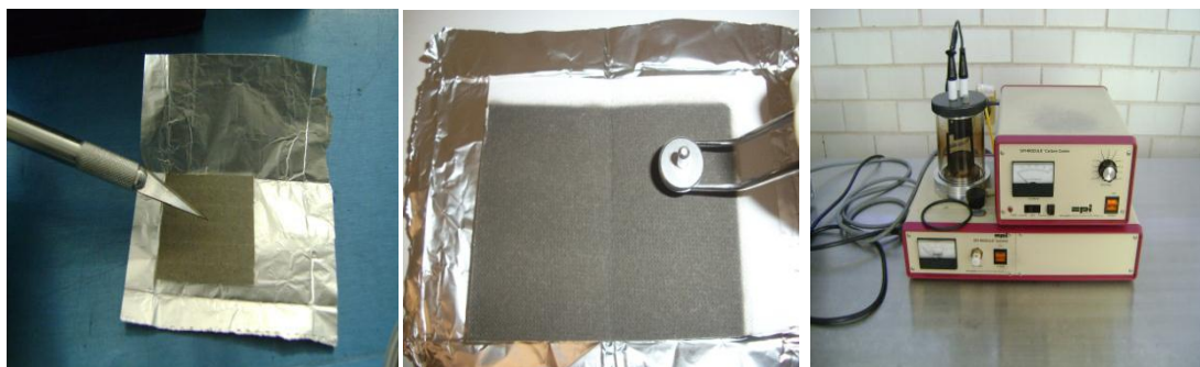
Figura 4.6. Imágenes que muestran el seccionado del filtro, técnica de adherencia y equipo utilizado para el recubrimiento con carbón, respectivamente.
