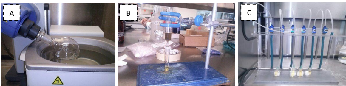
Figura 4.12. Preparación del extracto orgánico para CG-EM: A) Reducción y concentración. B,C) Filtrado y ajuste de volumen.
