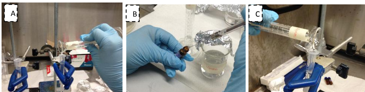
Figura 4.14. A) Limpieza y acondicionamiento, B) Secado y adición de muestra sobre cartucho, C) Fraccionamiento y purificación.
