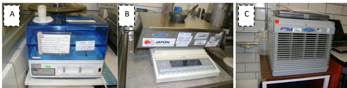
Figura 4.4. Equipo utilizado en el acondicionamiento de filtros; Propiedad de DGCENICA-INE. A) Humidificador, B) balanza digital para filtros de alto volumen, C) Deshumidificador.
