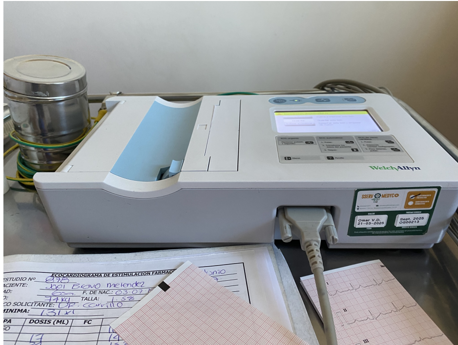
Figura 2.2: Electrocardiógrafo comercial (Welch Allyn) con papel cuadrículado e impresión de derivaciones I, II y III. Se usa como referencia de calidad de señal y de la interfaz tradicional para comparar con el sistema propuesto basado en OpenBCI.
