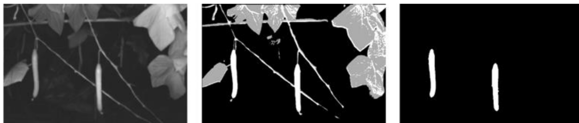
Figura 1.7. Imágenes del sistema de visión aplicando filtros para la detección de pepinos (Tomado de [9]).
