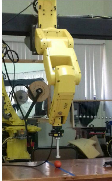
Figura 4.3. Ubicación del tomate debajo del efector final.
