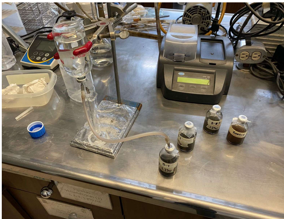
Figura A.5. Medición de metano por método volumétrico.
