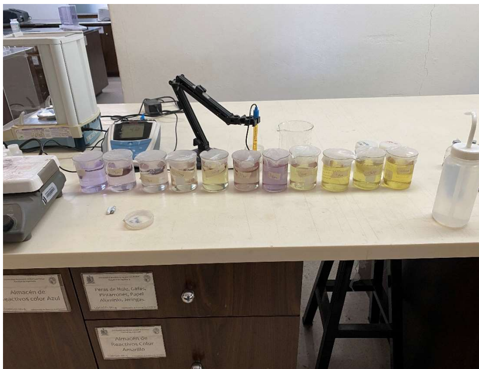
Figura A.4. Preparación de soluciones para actividad metanogénica específica expuesta a concentraciones incrementales de Cr (VI).
