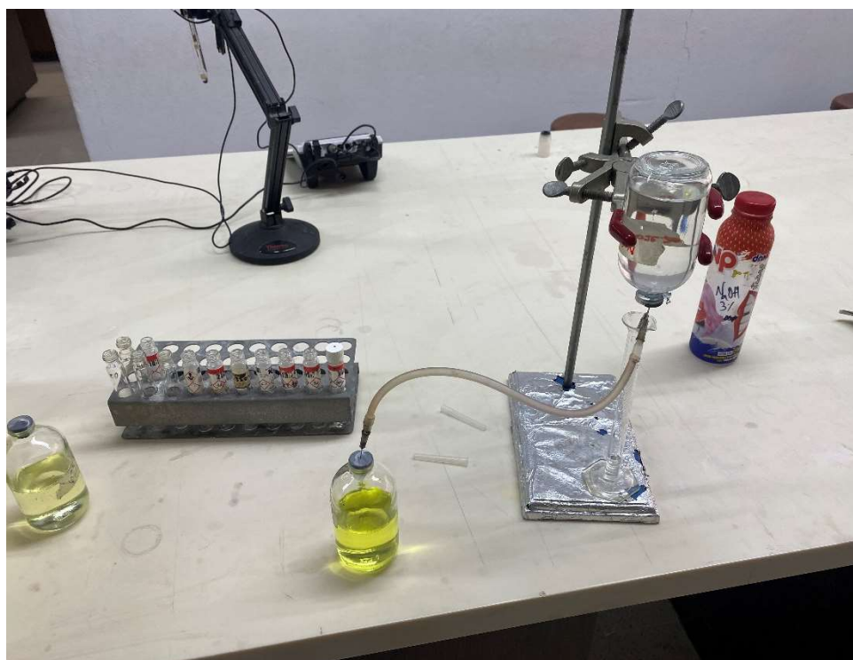
Figura A.8. Medición de metano en cinética química.
