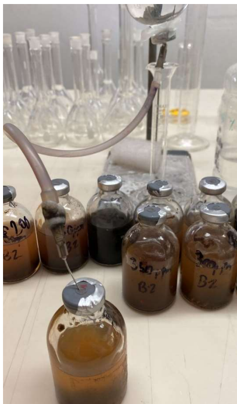
Figura A.6. Medición de metano a botellas expuestas a concentraciones incrementales de Cr (VI), se observa cambio en la coloración de la botella que indica reducción de Cr (VI).
