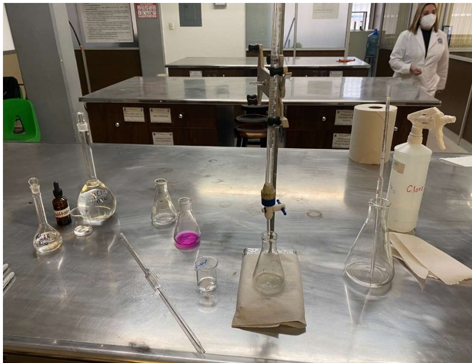
Figura A.1. Valoración ácido-base del HCl con NaOH empleando fenoftaleína como indicador.
