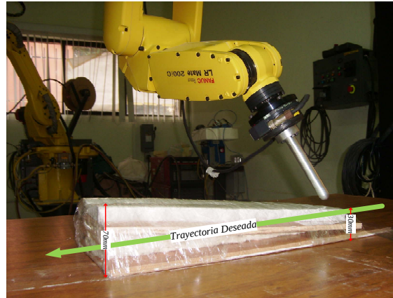
Figura 3.8. Plataforma experimental para control de impedancia.
