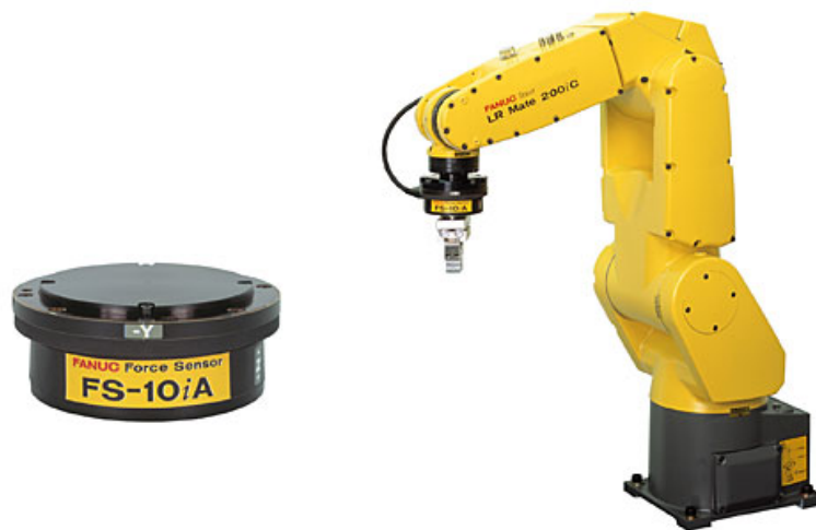
Figura C.1. Sensor de Fuerza FANUC FS-10iA
