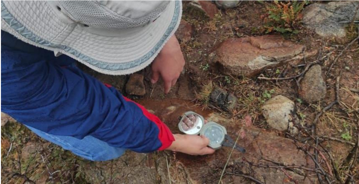
Figura 12. Medición de rumbos y de echados de discontinuidades mediante una brújula geológica durante el trabajo de campo en la zona de estudio.
