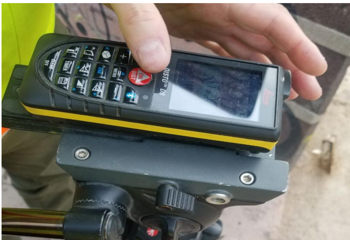
Figura 15. Distanciómetro laser configurado en campo.
