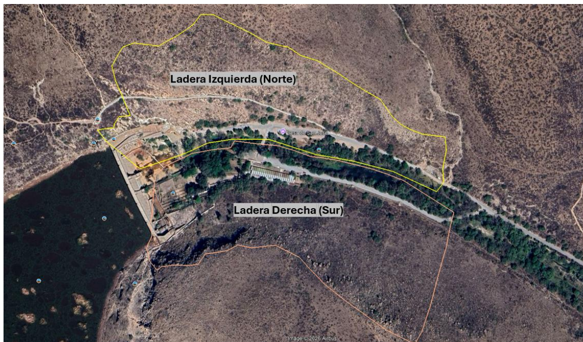
Figura 32. Ubicación de los perímetros de la zona de peligro por caída de bloques, basado en el programa IS GeoMassi.
