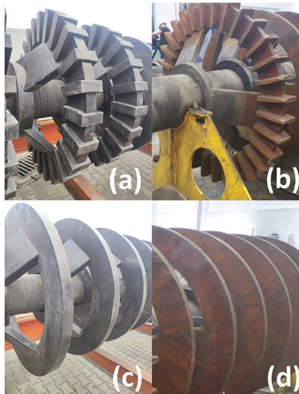
Figura 13.-Rotores de molienda HIGmill. Almenados y planos de caucho (a, c) y acero (b, d). (Altun et al, 2023).
