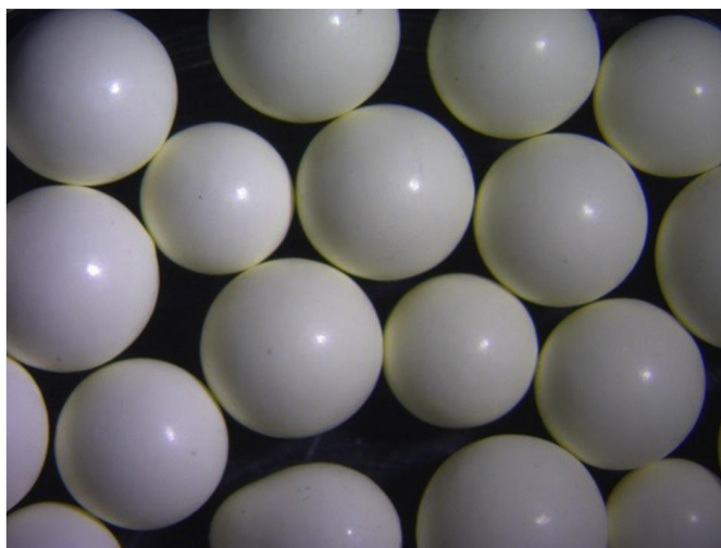
Figura 14.- MINERAX bolas de cerámica de 75% de alúmina y 25% de zircón. (Hassall et al, 2016).
