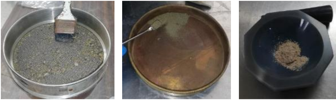
Figura 5.13 Proceso de preparación de la muestra FLX-01 para ingresarla al MEB. a) tamizado de la muestra, b) transferencia de la muestra al mortero, c) molienda de la muestra en el mortero.
