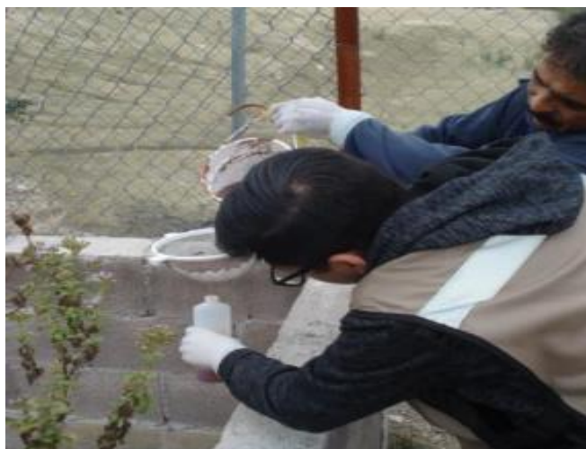
Figura 5.5 Muestreo de sedimentos de la fosa de lixiviados.
