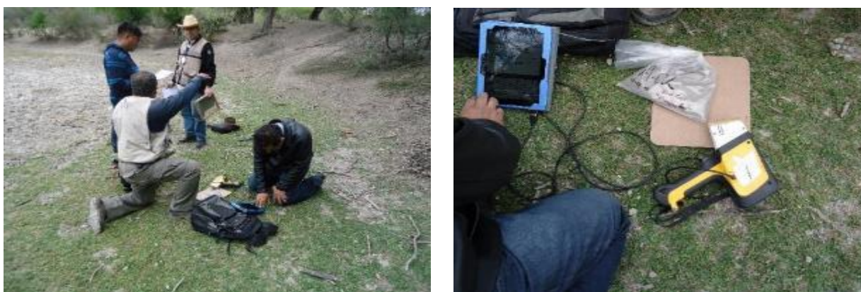
Figura 5.7 Medición el análisis en campo de las muestras en campo en las muestras de sedimentos y suelo con el espectrómetro de fluorescencia de rayos X portátil.
