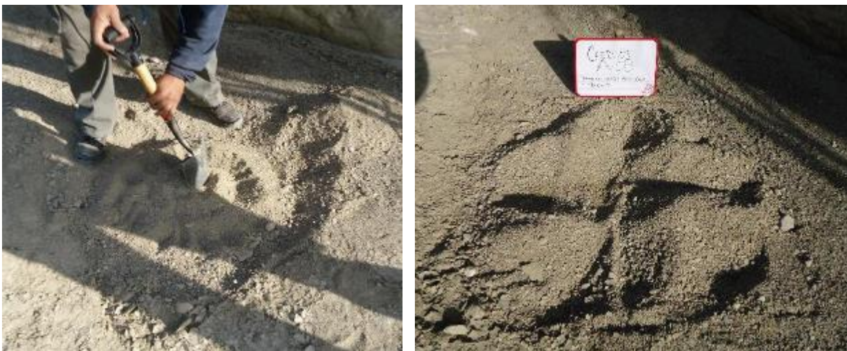
Figura 5.3 Muestreo superficial de sedimentos en el cauce del arroyo.
