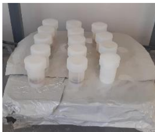
Figura 5.11 Tratamiento químico de las muestras. a) Adición de una mezcla de 1 ml de \text{HNO}_3 y HF, b) Reflujo de los viales con el encendido de las placas a 100^\circ\text{C} .
