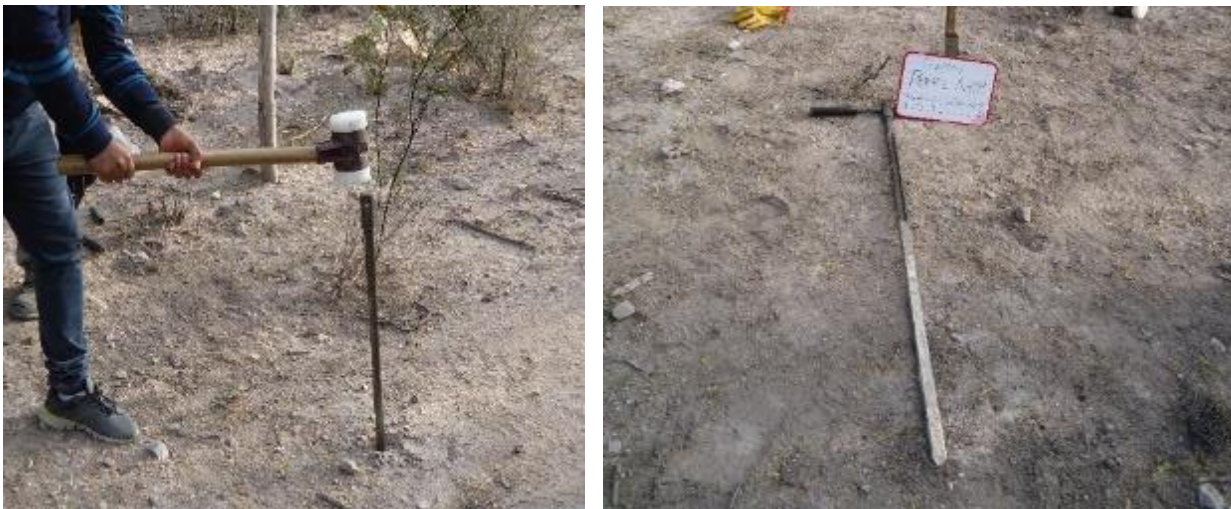
Figura 5.4 Muestreo de suelo con barrenador a 1.5 m de profundidad.
