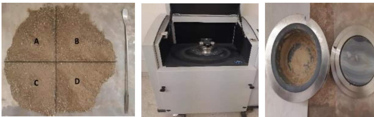
Figura 5.9. Preparación de muestras antes de ingresar al ICP-MS, a) Cuarteo del material recolectado, b) Ingreso del material al molino en un mortero de ágata, c) Material molido al tamaño de talco.
