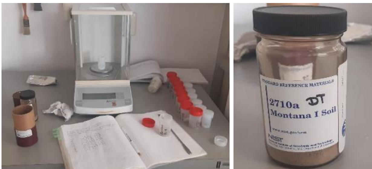
Figura 5.10 a) Bitácora con el registro del peso de muestra e identificación de viales. b). Montana I Soil utilizado como material de referencia.
