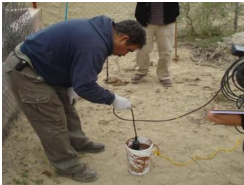
Figura 5.8 Análisis en campo de lixiviados con sonda multiparámetro.
