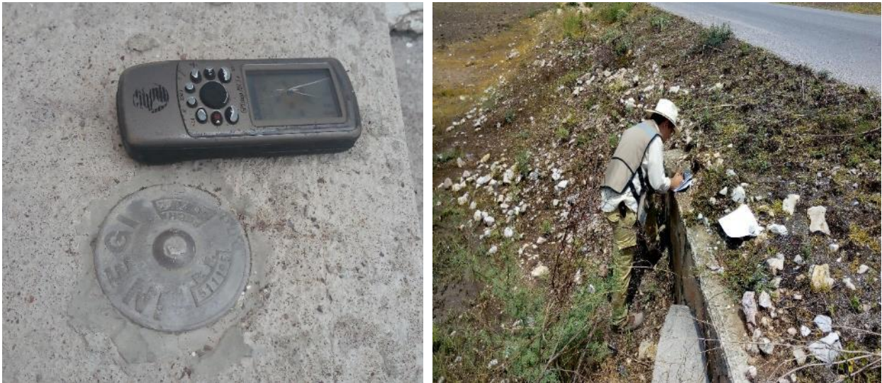
Figura 4.2 Ajuste de los datos obtenidos con el GPS (marca Garmin) y comparación con puntos de la Red Geodésica Nacional Pasiva del INEGI.
