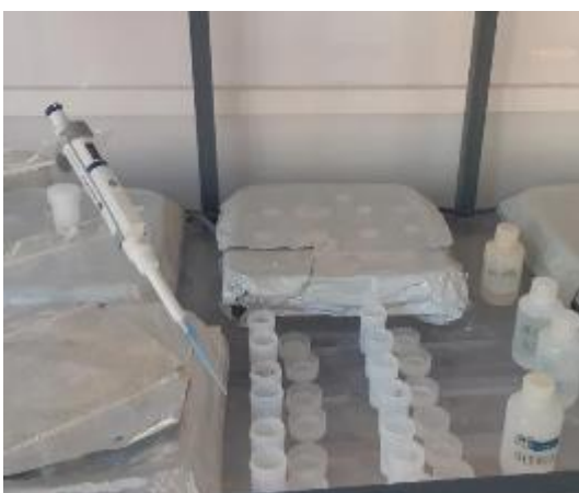
Figura 5.11 Tratamiento químico de las muestras. a) Adición de una mezcla de 1 ml de \text{HNO}_3 y HF, b) Reflujo de los viales con el encendido de las placas a 100^\circ\text{C} .
