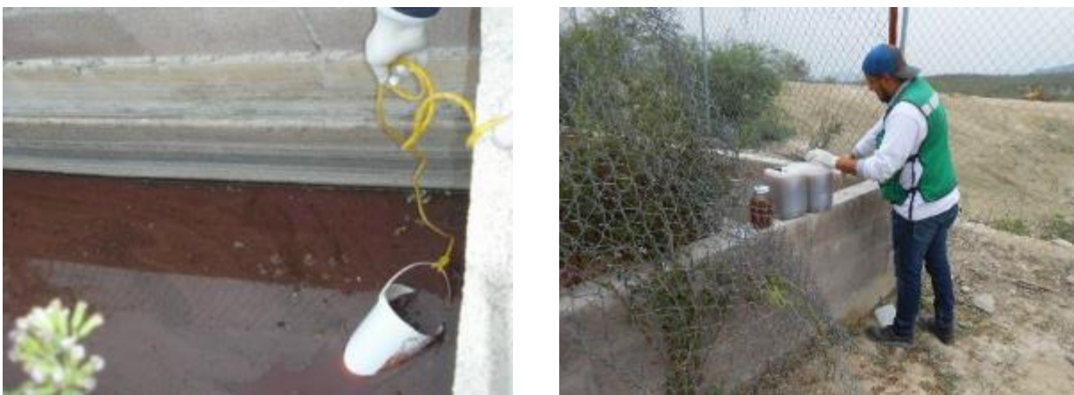
Figura 5.6 Muestreo de lixiviados en campo.
