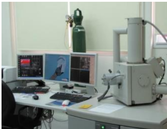
Figura 5.12 Microscopio electrónico de barrido y su funcionamiento (Caneiro et al , 2010).
