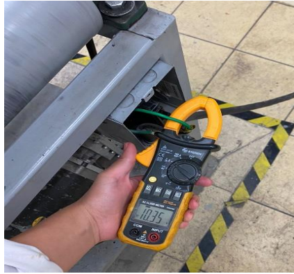
Figura 8. Medición del amperaje consumido en el molino a cada tiempo de molienda
