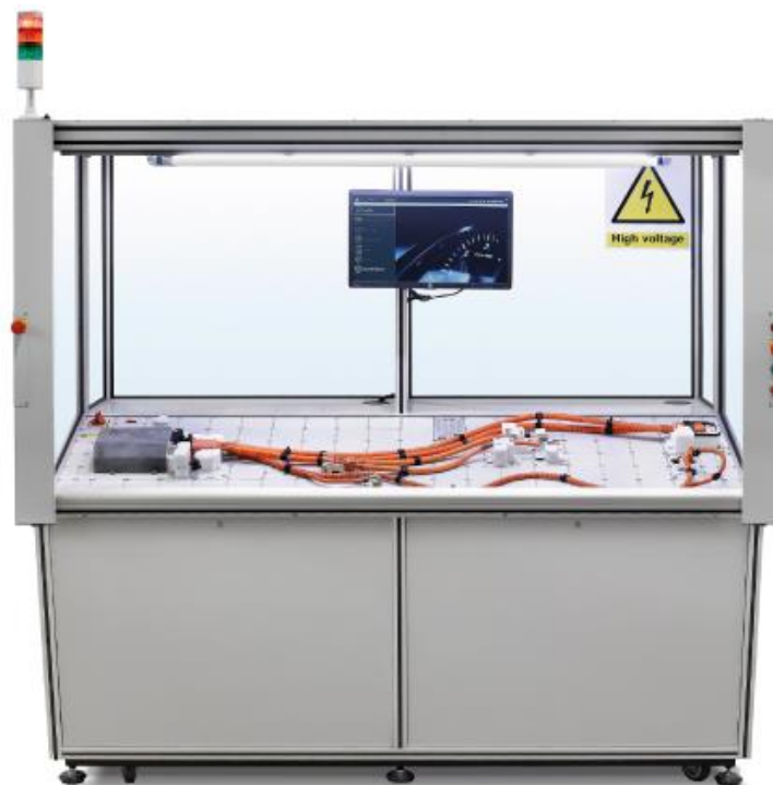
Figura 1-2: Imagen de un banco de pruebas para la verificación eléctrica final de un arnés de alto voltaje (Emdep, 2022).
