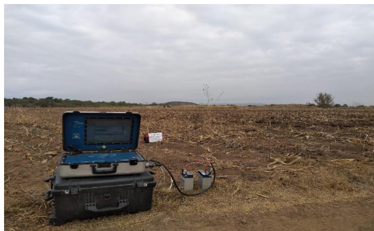
Fig. 22. Dispositivo TerraTEM en zona de estudio La Loma, con extensión de bobina tipo single loop de dimensiones 50m x 50m.
