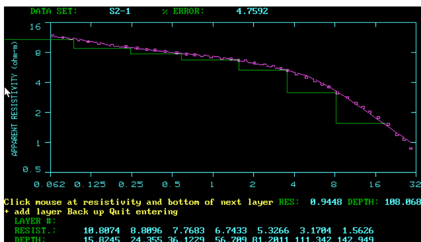
Fig. 25. Ejemplo de modelado de capas planas en el programa Temix a partir de curvas de resistividad aparente en función del tiempo obtenidas en campo.
