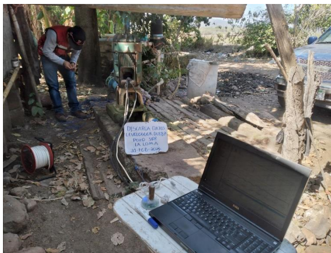
Fig. 19. Programación e instalación de sondas TD-Diver y Baro-Diver para pruebas de bombeo en zona de estudio La Loma.
