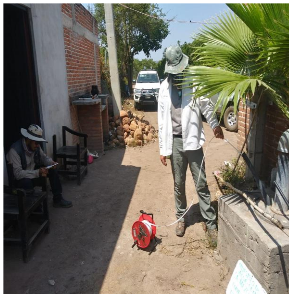
Fig. 21. Medición de nivel estático en pozo de uso agrícola con sonda Solinst graduada en zona de estudio La Mezclita .
