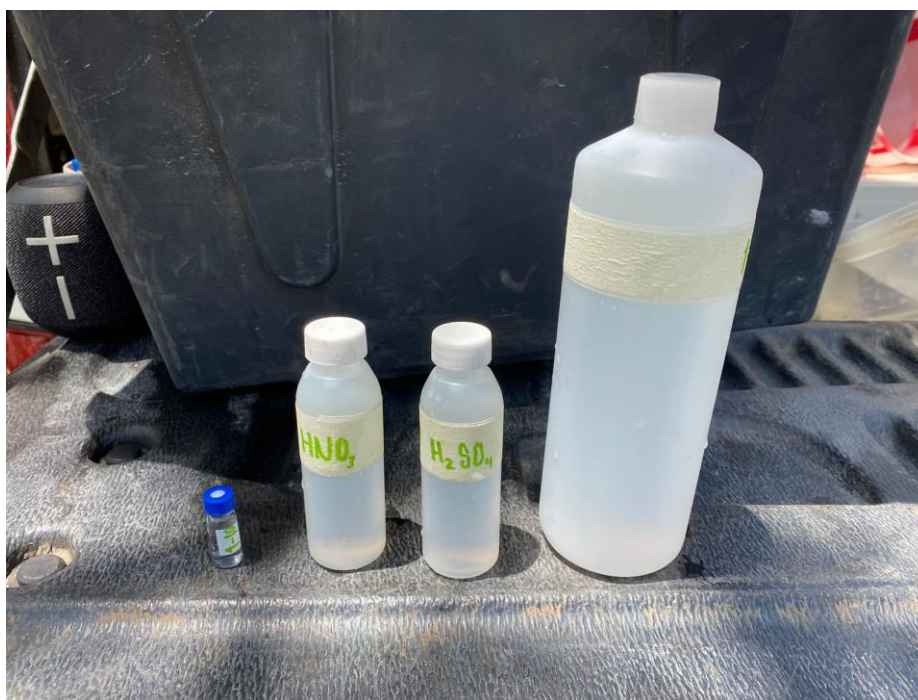
Fig. 31. Muestras obtenidas de aprovechamientos para análisis isotópico y de elementos mayores, menores y traza en agua subterránea.
