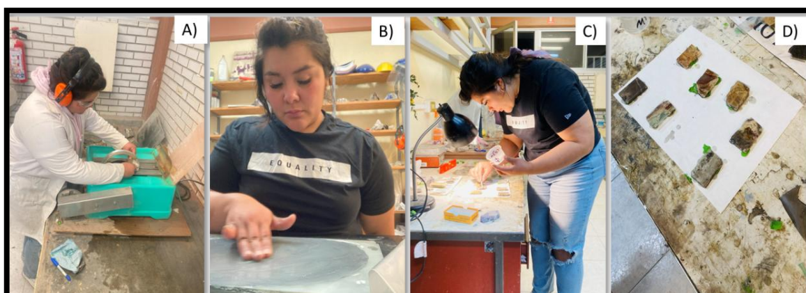
Figura 3. Fotografías de preparación de muestras A) Corte de prismas rectangulares B) Etapa de desbaste C) Etapa de pegado D) Resultado del pegado a láminas
