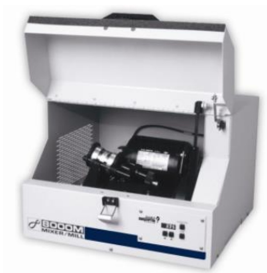
Figura 4 Molino de alta energía SPEX-8000M empleado para realizar el empape y el aleado mecánico.
