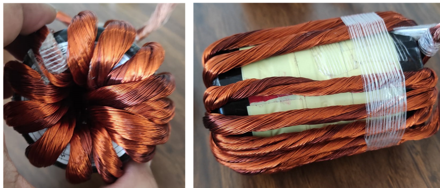
Figura A.3. Resultado final del inductor L_2 construido.
