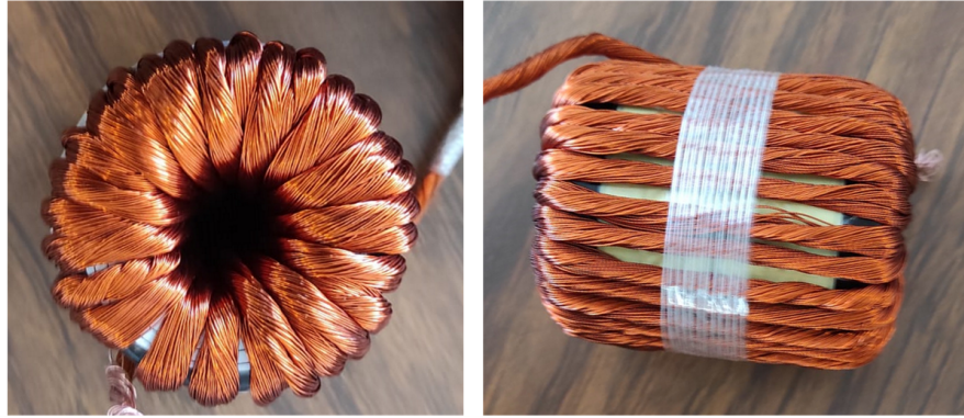
Figura A.2. Resultado final del inductor L_B construido.
