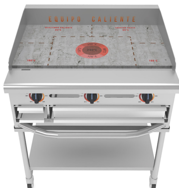
Figura 82: Prototipo de plancha de 36" sobre base, con activación termocromática en indicadores de temperatura. Elaboración propia.
