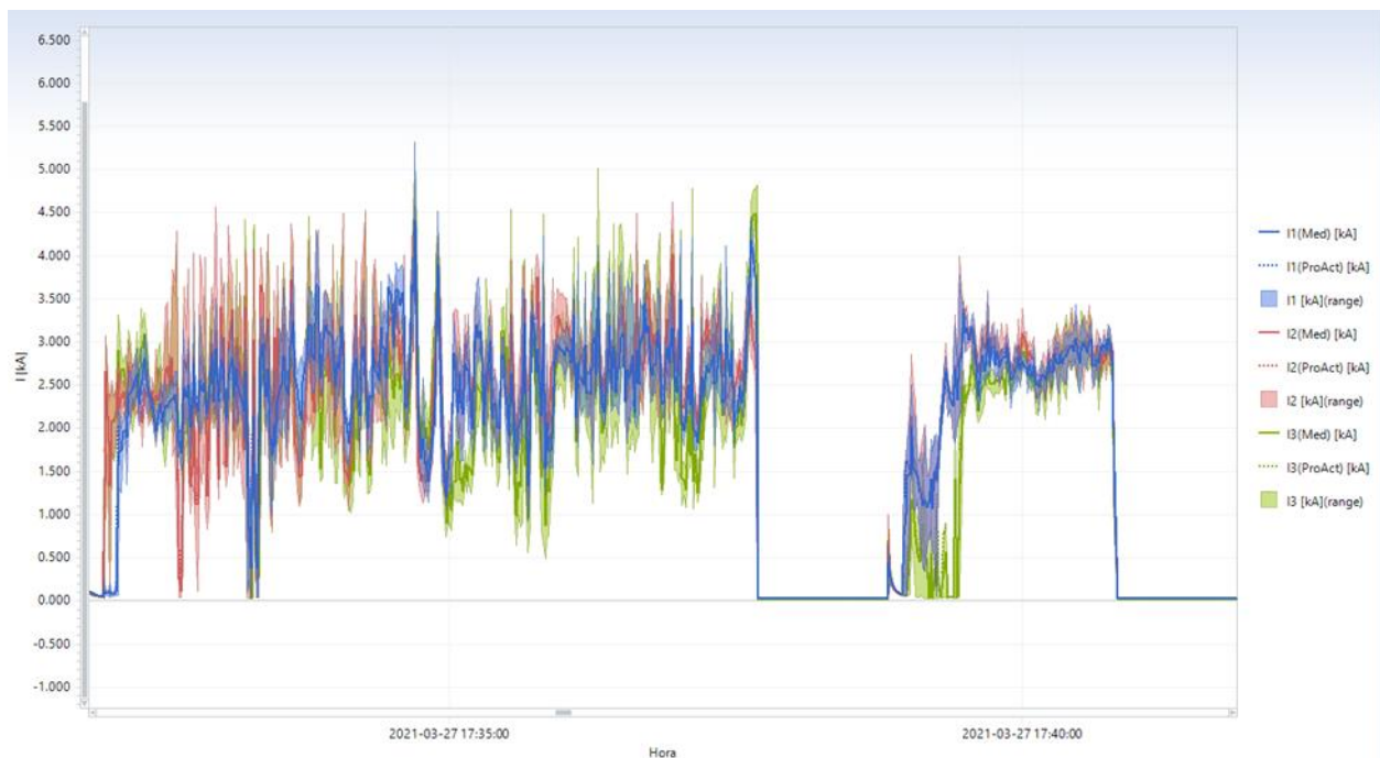
Figura 4.1 Corrientes Lado Primario Transformador horno de fusión.
