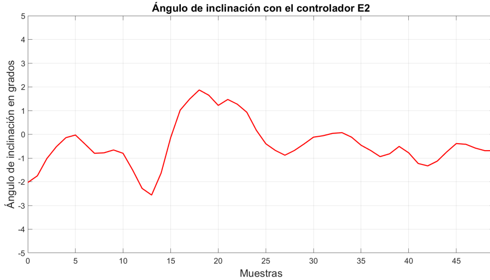
Figura 4.10. Medidas del ángulo de inclinación del robot con el controlador por E2.
