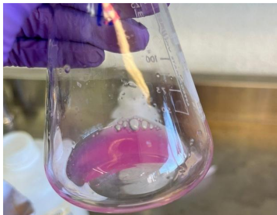
Figura A. 10. Alícuota titulada en la determinación de sitios activos.
