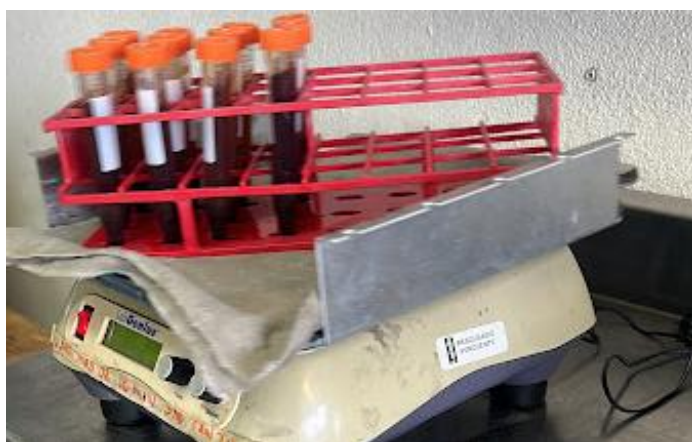
Figura A. 12. Pruebas en lote de adsorción con cáscara de piña en contacto con solución de Pb (II) .
