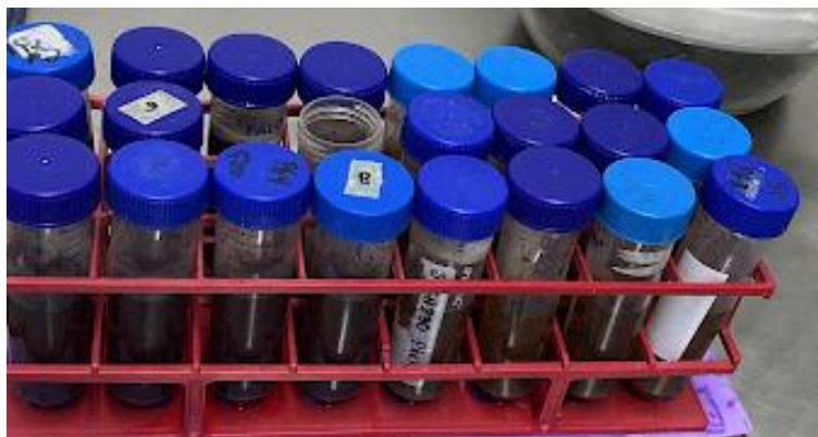
Figura A. 12. Pruebas en lote de adsorción con cáscara de piña en contacto con solución de Pb (II) .
