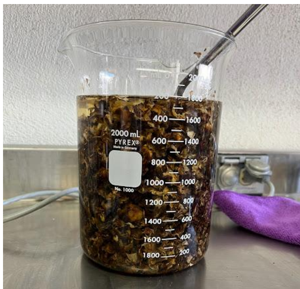
Figura A. 2. Cáscara de piña en ácido clorhídrico 0.1 M.
