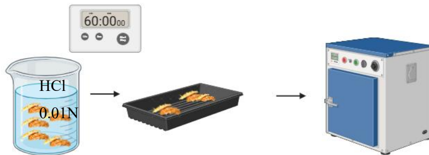
Figura 2.2 Esquema para el lavado con ácido de la cáscara de piña (elaboración propia).
