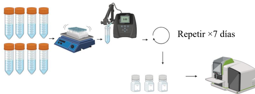
Figura 2.5 Esquema para el método de adsorción para pruebas en lote (elaboración propia)
