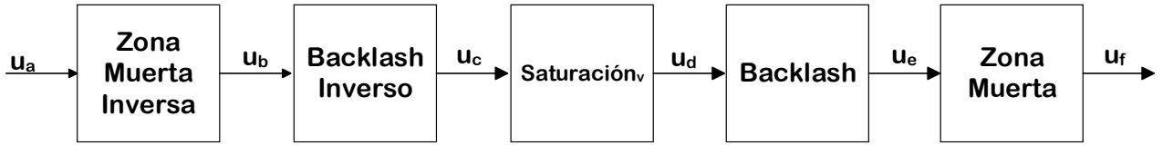
Figura 1.14: Diagrama a bloques de no linealidades combinadas.
