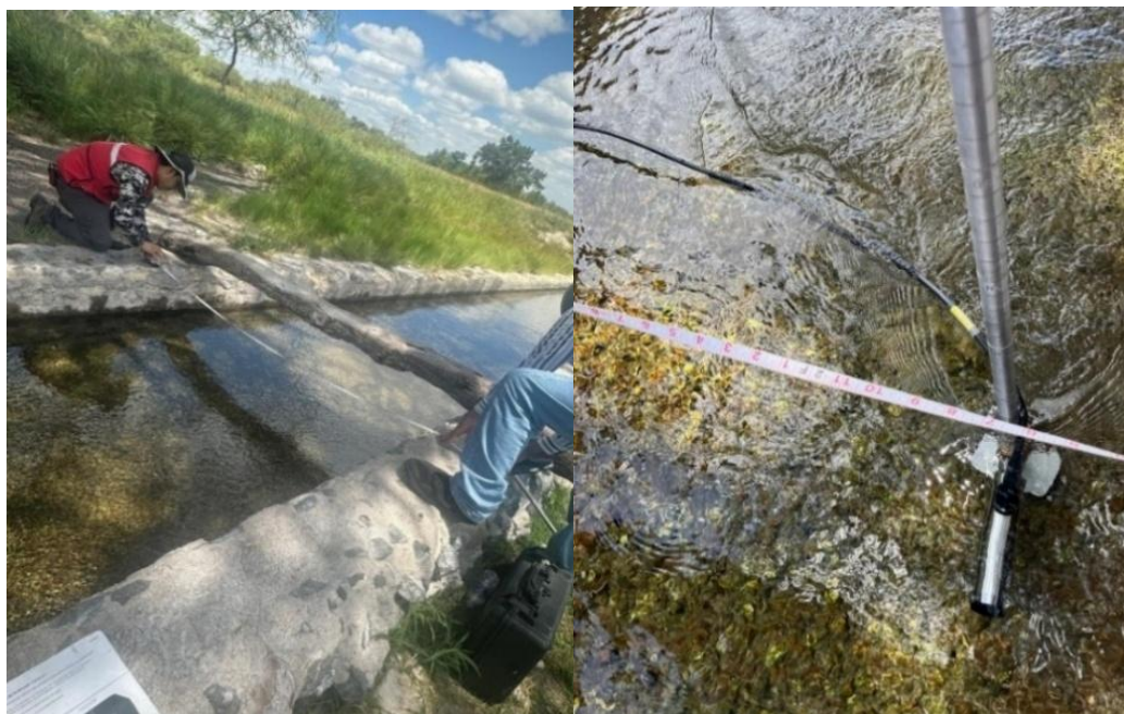
Figura 21. Medición de la sección transversal en el canal de Los Peroles. Izquierda ancho, derecha profundidad.
