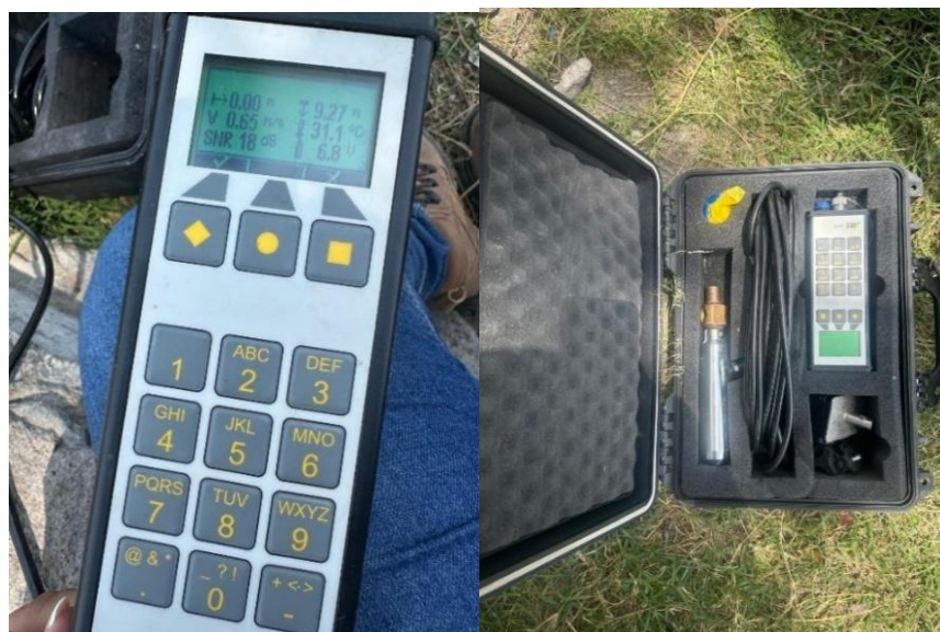
Figura 22. Obtención de la velocidad con el medidor de flujo acústico y digital para cauces descubiertos.
