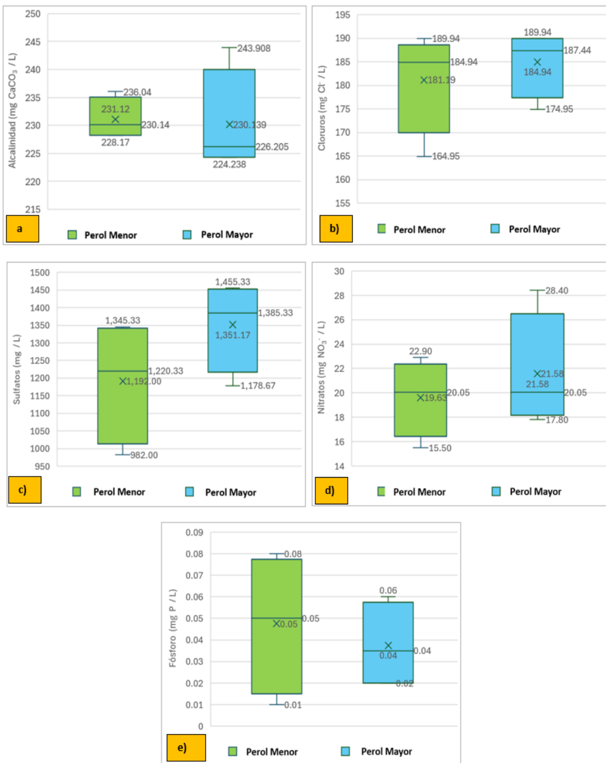
Figura 41. Distribución de los parámetros fisicoquímicos en laboratorio para el Perol Menor y el Perol Mayor mediante gráficas de cajas y bigotes. a) alcalinidad, b) cloruros, c) sulfatos, d) nitrógeno total, e) fósforo total. (n= 4, \alpha=0.05 , p>0.05 ).
