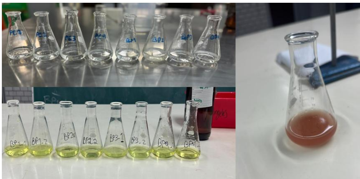
Figura 24. Determinación de cloruros por el método argentométrico.
