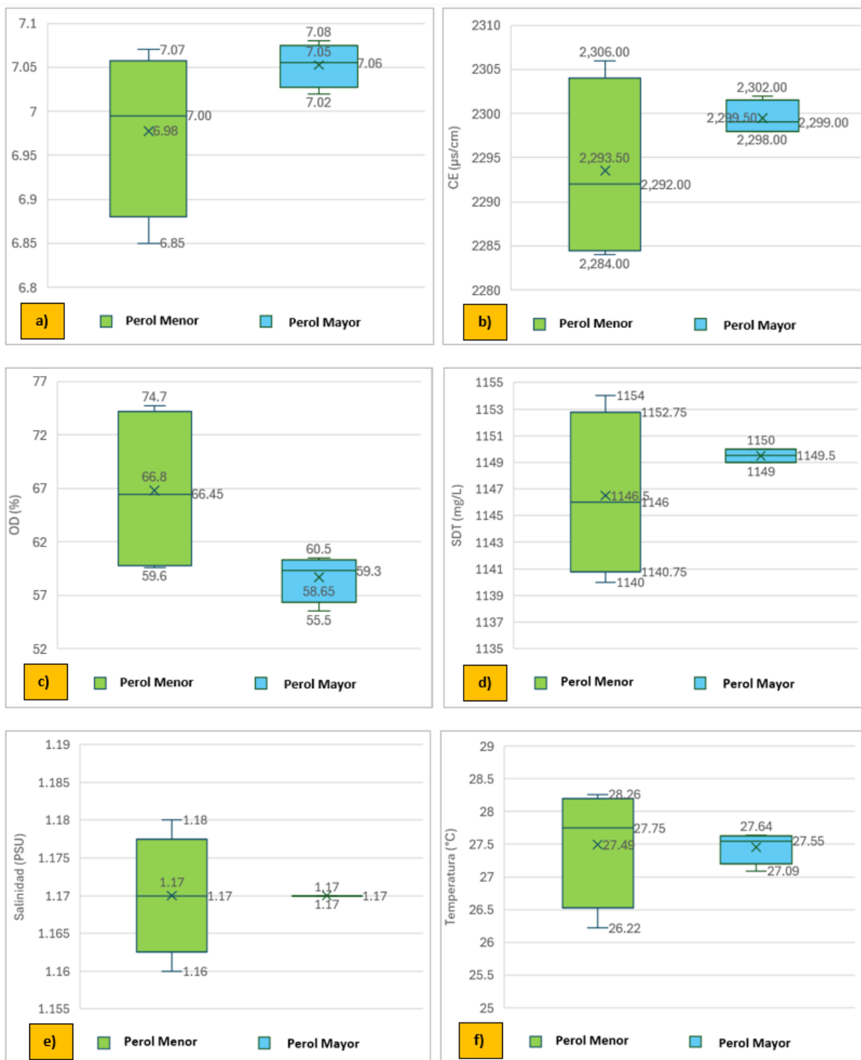
Figura 40. Distribución de los parámetros fisicoquímicos en campo para el Perol Menor y el Perol Mayor mediante gráficas de cajas y bigotes. a) pH, b) conductividad eléctrica, c) oxígeno disuelto, d) sólidos disueltos totales, e) salinidad, f) temperatura. (n= 4, \alpha=0.05 , p>0.05 ).
