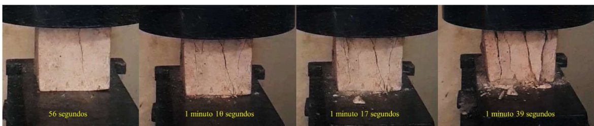
Figura 51. Evolución de la destrucción de la brecha (rudstone) de Kabah (M21) debido a una fuerza compresiva.
