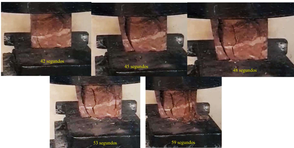
Figura 52. Evolución de la destrucción de la brecha (floatstone) de Sayil (M50) debido a una fuerza compresiva.
