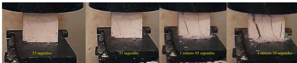
Figura 53. Evolución de la destrucción de la caliza (wackestone) de Sayil (M54) debido a una fuerza compresiva.
