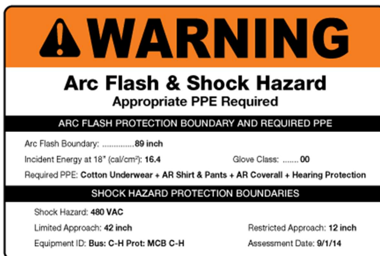
Fig.7 Ejemplo de una etiqueta de Arco Eléctrico
