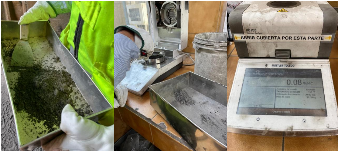
Figura 17. Toma de muestra para determinación de humedad en analizador.
