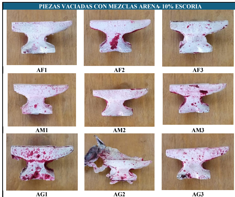
Figura 34. Evaluación con líquidos penetrantes de piezas vaciadas en mezclas arena- 10% escoria.
