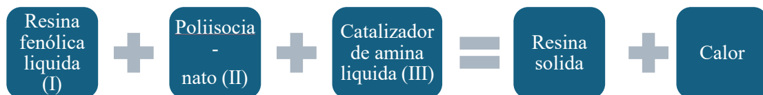
Figura 7. Reacción de polimerización para el sistema aglomerante fenólico uretano [21].
