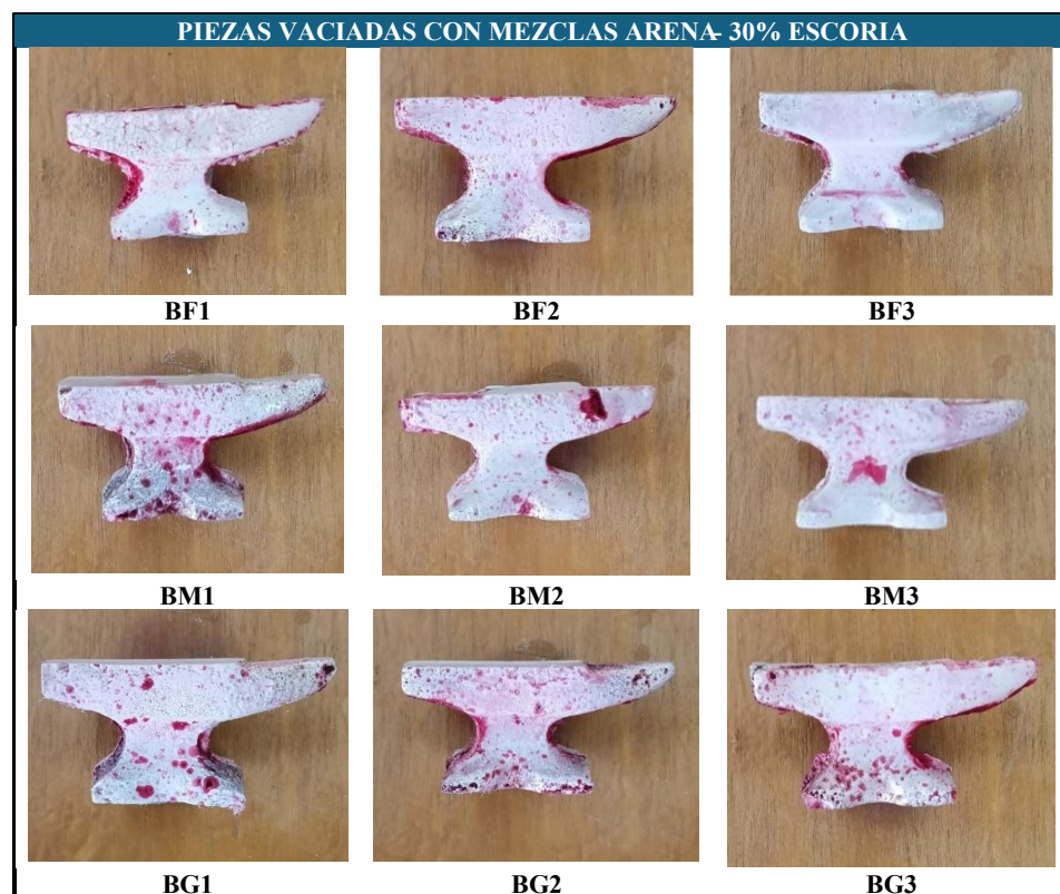
Figura 35. Evaluación con líquidos penetrantes de piezas vaciadas en mezclas arena- 30% escoria.
