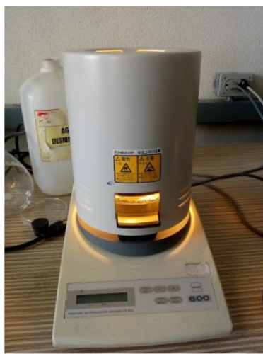
Figura 16. Equipo de infrarrojo KETT
