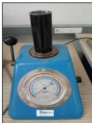
Figura 20. Permeámetro DISA para medición de permeabilidad de probetas elaboradas con sistema autofraguante fenólico- uretano.
