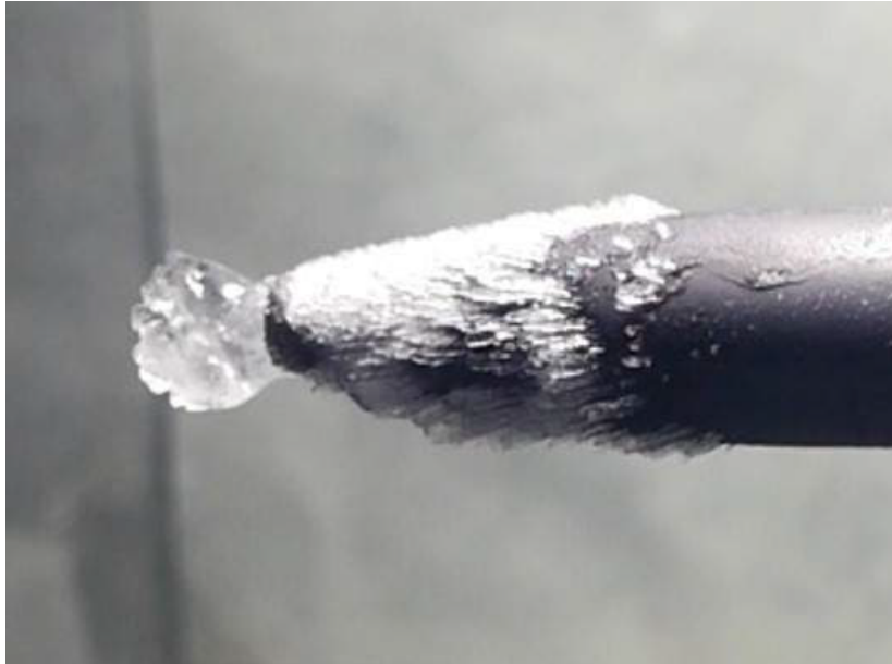
Figura 2.18: Evidencia experimental de acumulación de hielo sobre el mismo modelo de tubo Pitot [4].
