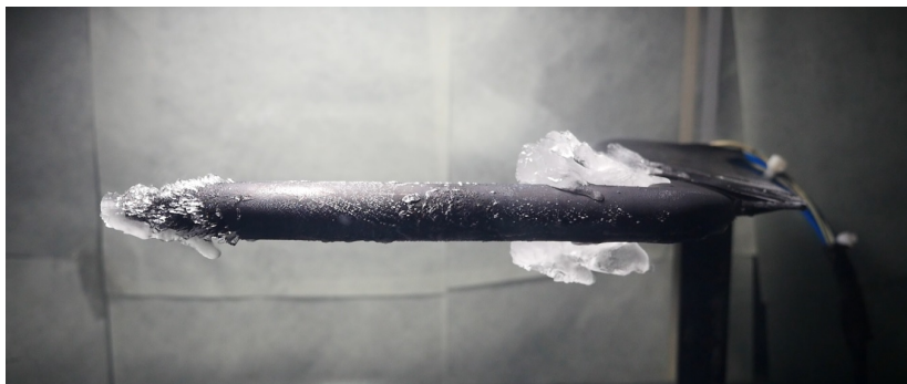
Figura 1.4: Estudio experimental de la formación de hielo en un tubo Pitot [4].
