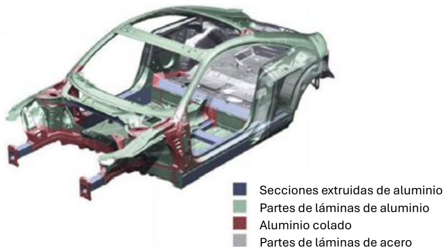
Figura 1.1. Partes de automóviles donde se utilizan aleaciones de aluminio [1].
