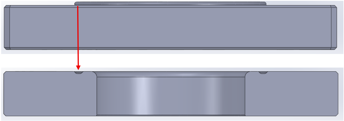
Figura Anexo 1.2. Cambio de ranura a hendidura en sujetador.
