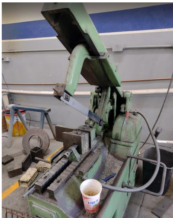
Figura Anexo 3.9. Cortadora utilizada para cortar la barra de 2.25 pulgadas.
