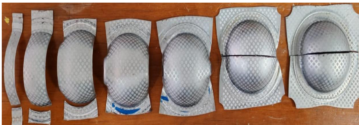
Figura 3.26. Blancos utilizados en la prueba de Nakazima después de la prueba.
