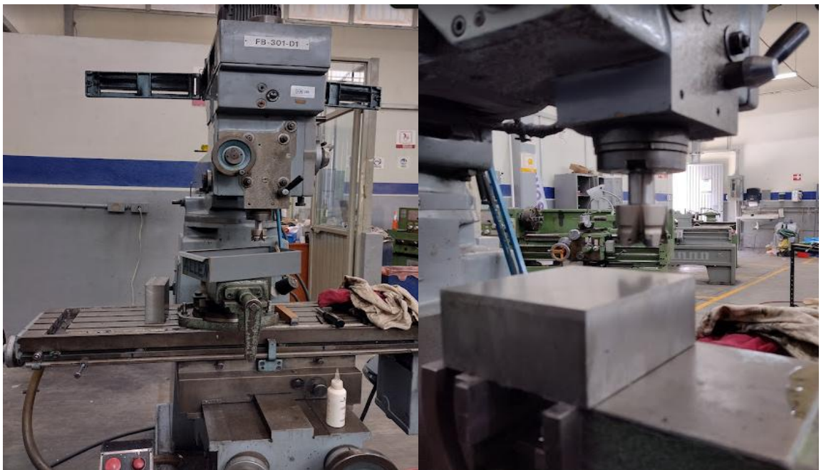
Figura Anexo 3.2. Operación de reducción de espesor en la fresadora.
