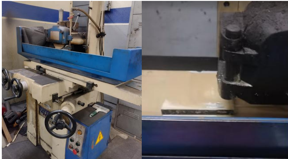
Figura Anexo 3.3. Operación de acabado superficial en rectificadora.
