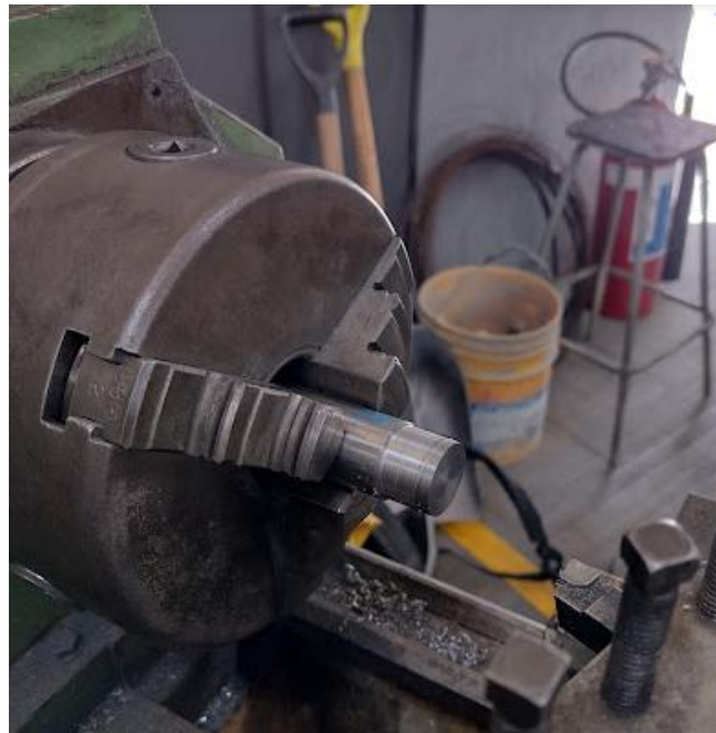
Figura Anexo 3.8. Reducción de dimensiones de las barras en el torno.
