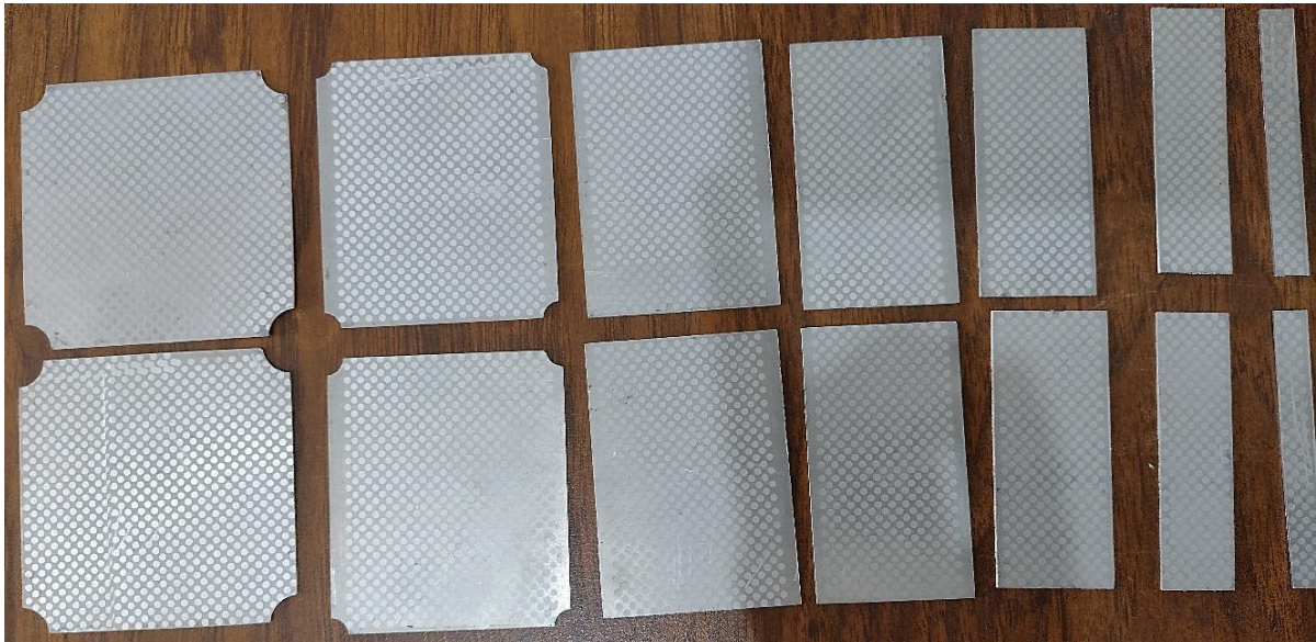
Figura 2.12. Blancos para la prueba de Nakazima con rejilla de círculos grabada.
