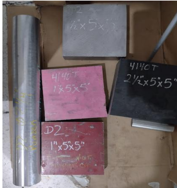
Figura Anexo 3.1. Barras y bloques de acero en estado inicial utilizadas para las piezas.
