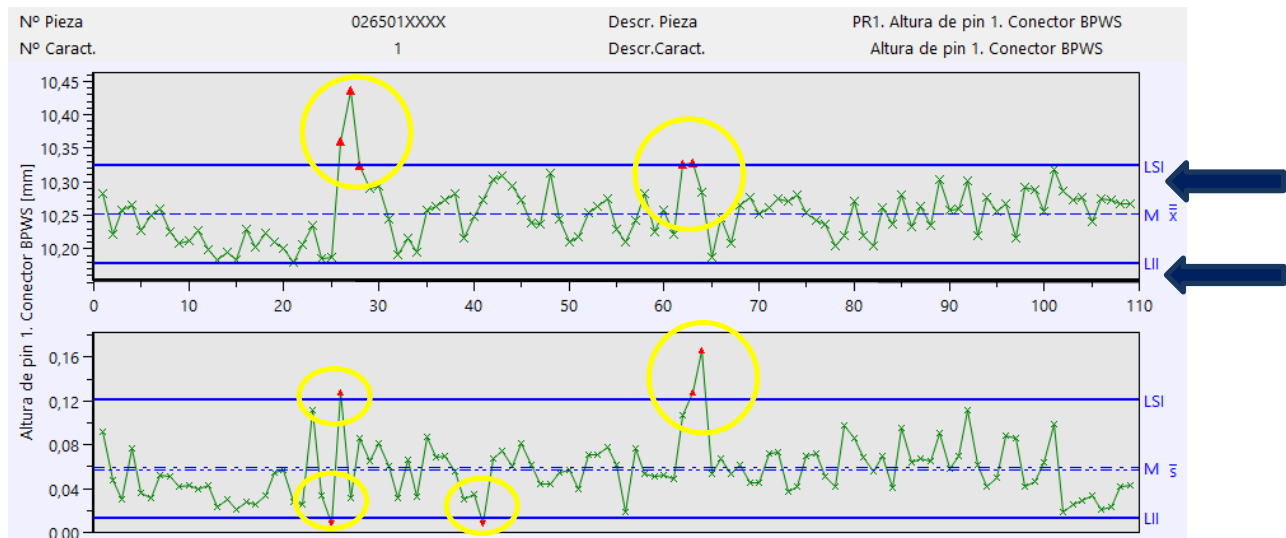
Figura 42. Gráfico 2 de control de calidad de la variable de altura de pin 1 de conector
