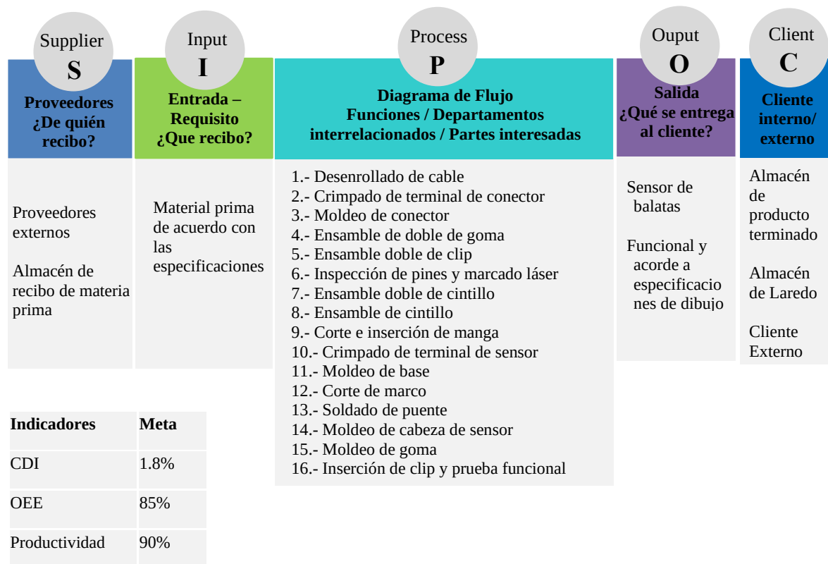
Figura 6. Diagrama de entradas y salidas del proceso de sensor de desgaste de balata. Fuente: Elaboración propia
