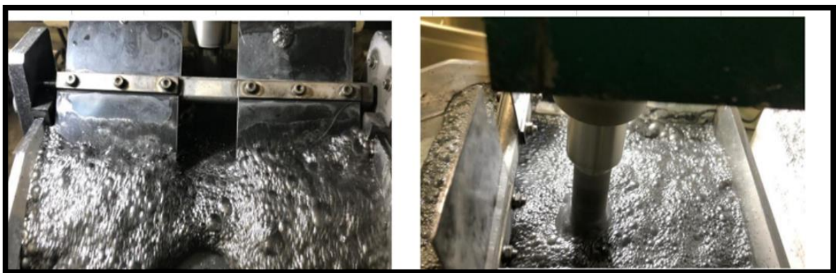
Figura 31. Celda de flotación laboratorio metalúrgico con paleteador automático.
