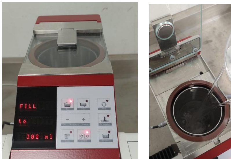
Figura 12. Limpieza de recámara del equipo.
