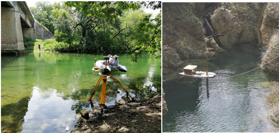
Figura 5.11. Aforo de caudales en los distintos puntos seleccionados.
