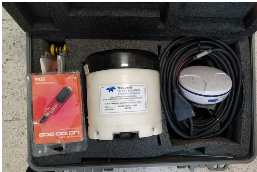
Figura 3.25. Equipo ADCP y GPS.
