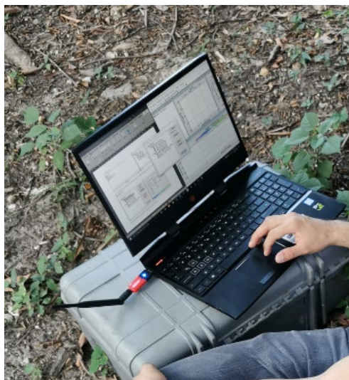
Figura 3.29. Laptop con WinRiver conectada al receptor de Bluetooth.
