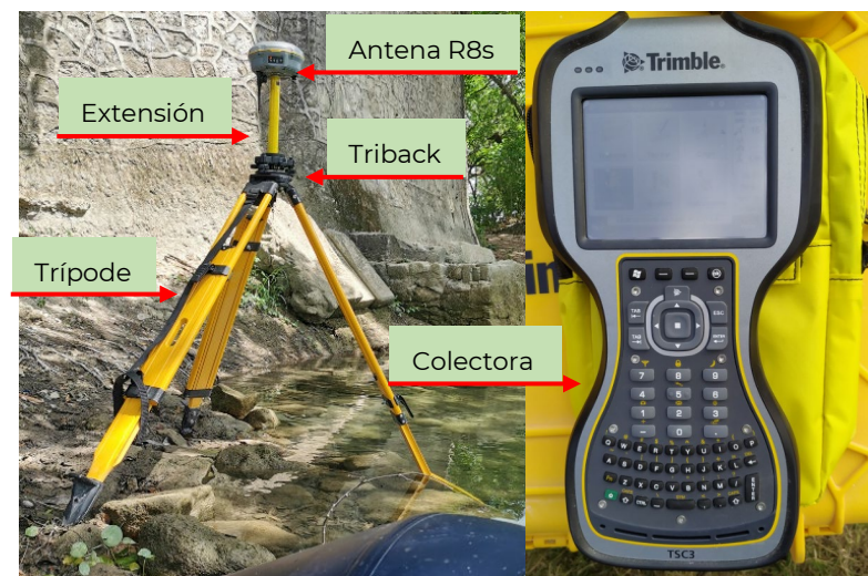
Figura 3.3. Equipo GNSS: antena R8s, trípode, triback y colectora TSC3.
