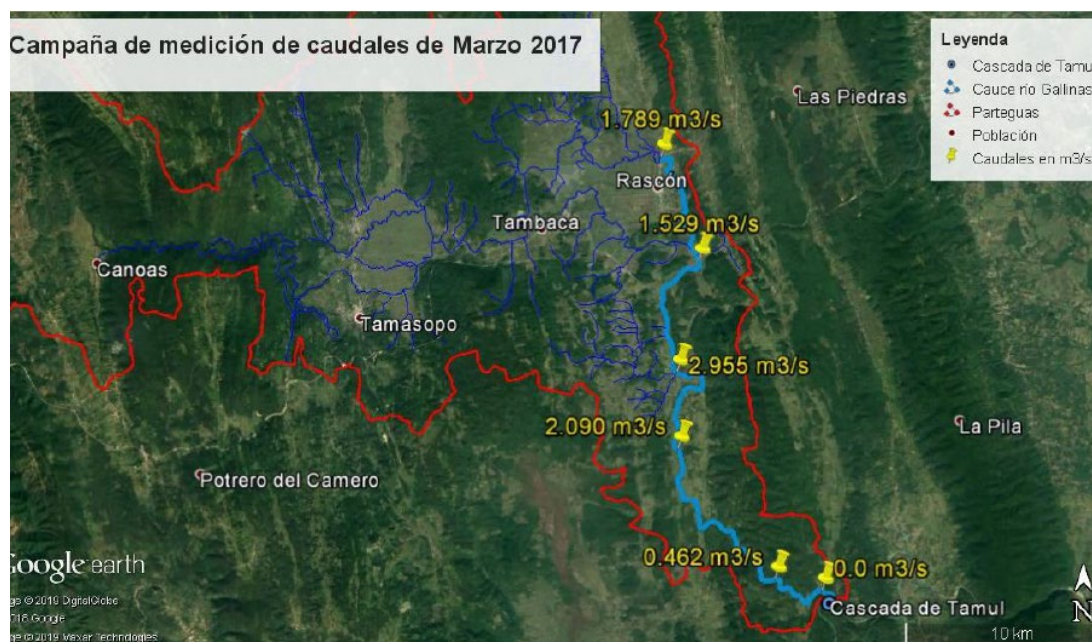
Figura 6.5. Campaña de medición de caudales, recuperada de Robles (2019).
