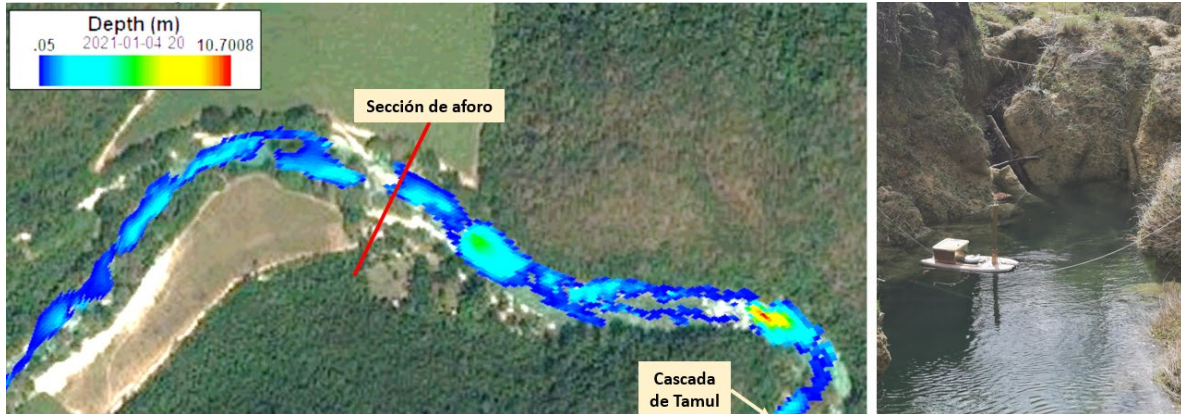
Figura 6.2. Monitoreo de caudales, modelo numérico y campaña de medición.
