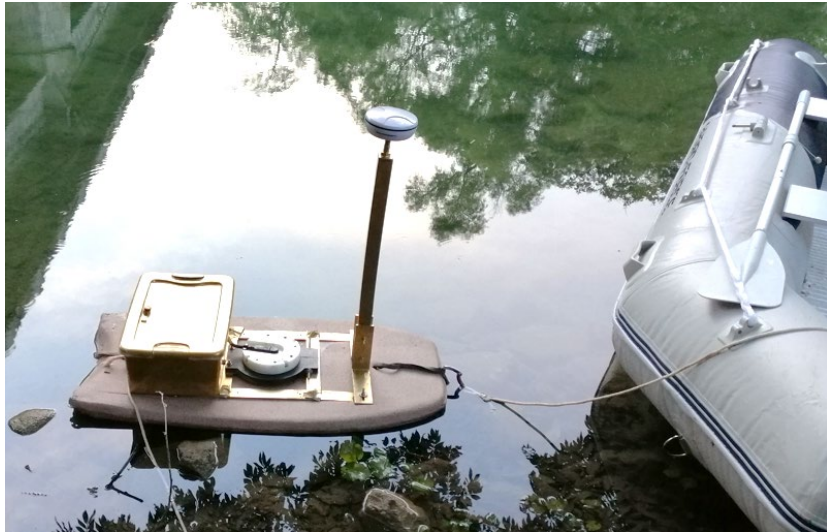
Figura 3.26. Hydroboard, ADCP, GPS, lancha y caja con baterías y conexiones.
