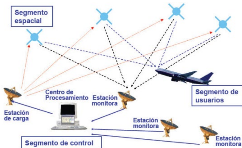
Figura 3.2. Estructura de un GNSS.
