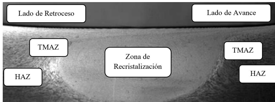
Figura 1.3 Zonas microestructurales en la soldadura FSW [2].
