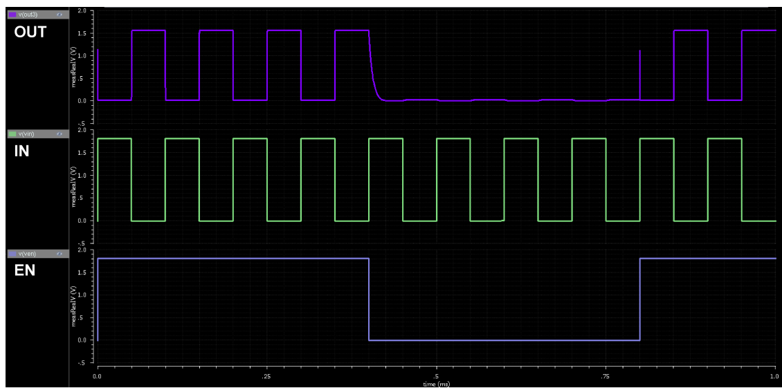
Figura 5.16: Respuesta transiente de la compuerta TRI-STATE NOT, opción 1.
