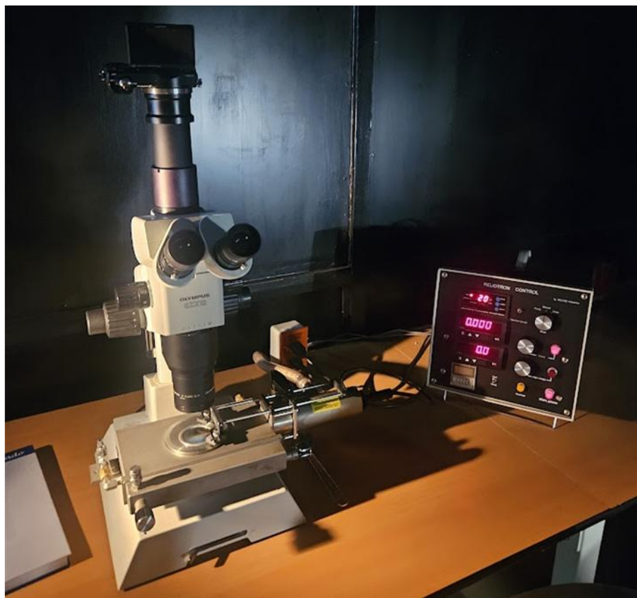
Figura 5. Microscopio óptico binocular de luz polarizada simple reflejada, marca Olympus SZX12 con una platina de CL de cátodo caliente marca Reliotron.
