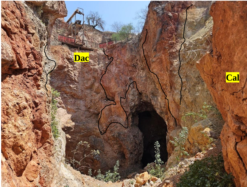
Figura 11. Vista del malacate tomada desde el acceso al tiro principal de la mina La Rosita. Las líneas señalan la interacción entre calizas (Cal) oxidadas y dacitas (Dac) alteradas, donde las calizas presentan recristalización y tonalidades rojizas debido a procesos de oxidación, las dacitas muestran ligera alteración argílica.
