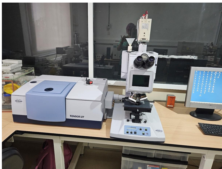
Figura 6. Espectrofotómetro de infrarrojo (IR) Bruker Tensor 27 utilizado para el análisis de espectroscopía FT-IR.
