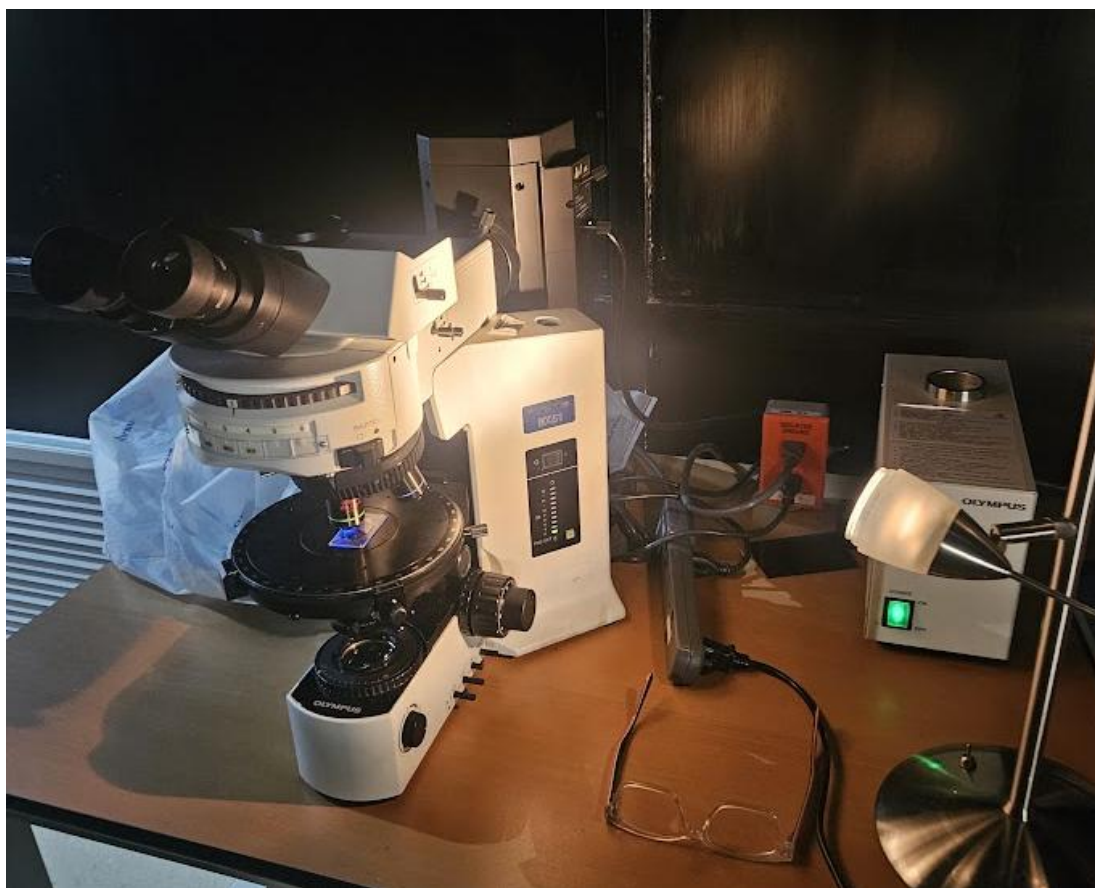
Figura 7. Microscopio Olympus BH2 equipado para realizar microscopía de fluorescencia UV con una cámara digital Qimaging MicroPublisher de 5 Mp., y un quemador Olympus con longitud de onda de 480 n.m.
