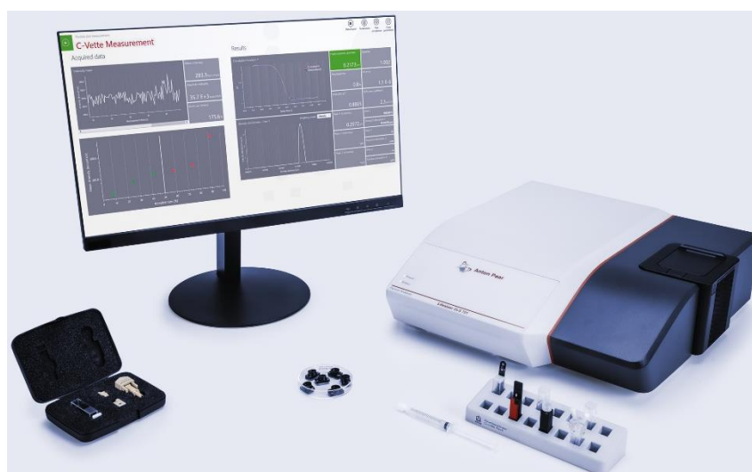
Figura 18. Instrumento Anton Paar modelo Litesizer DLS 700.
