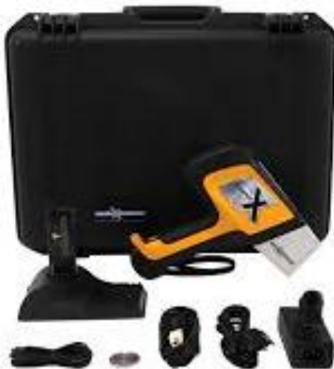
Figura 15. Analizador portátil Olympus modelo Delta Professional .
