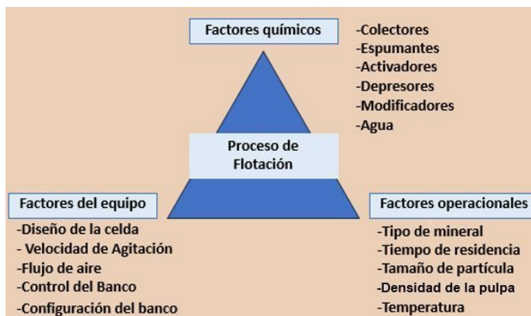
Figura 2. Variables que afectan en el proceso de flotación por espuma, modificado de Klimpel (1986).
