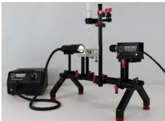
Figura 19. Goniómetro Ramme-Hart Instrument modelo 90U3CA.
