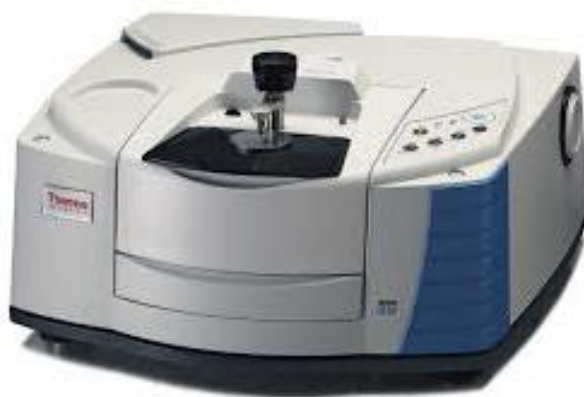
Figura 17. Espectrofotómetro Thermo Scientific Nicolet iS10.
