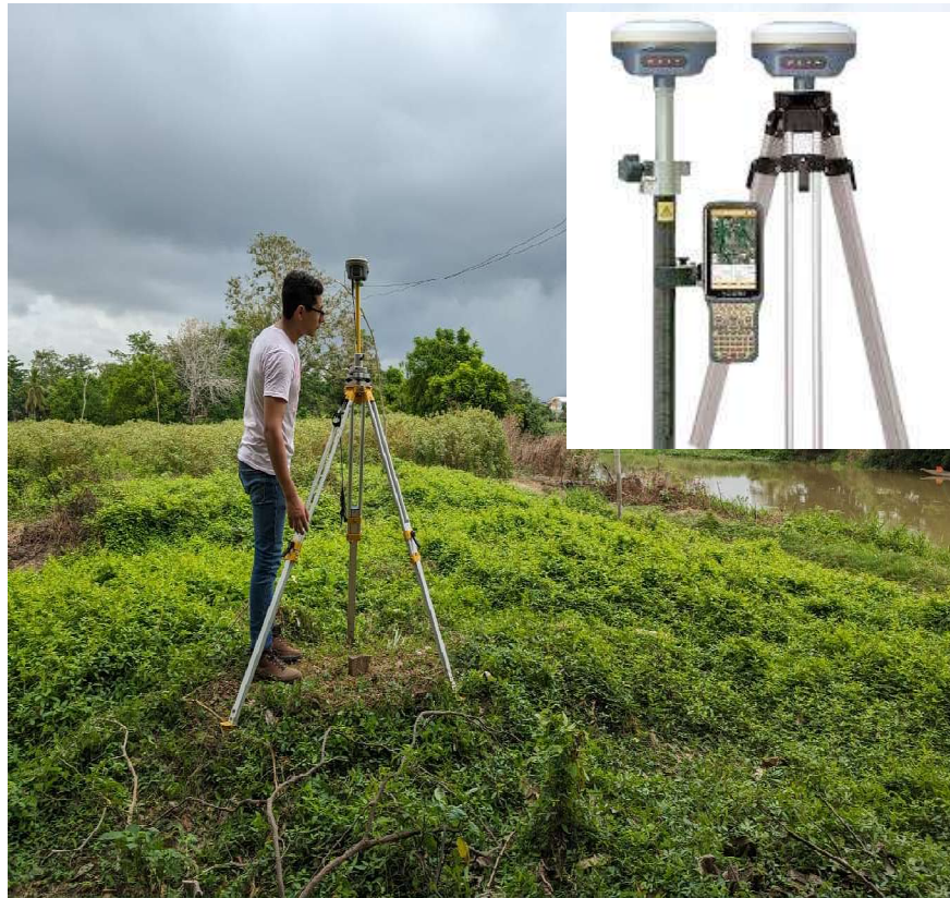
Figura 5. 6 Nivelación Topográfica con Sistema GPS. Equipo South GPS Satelital
