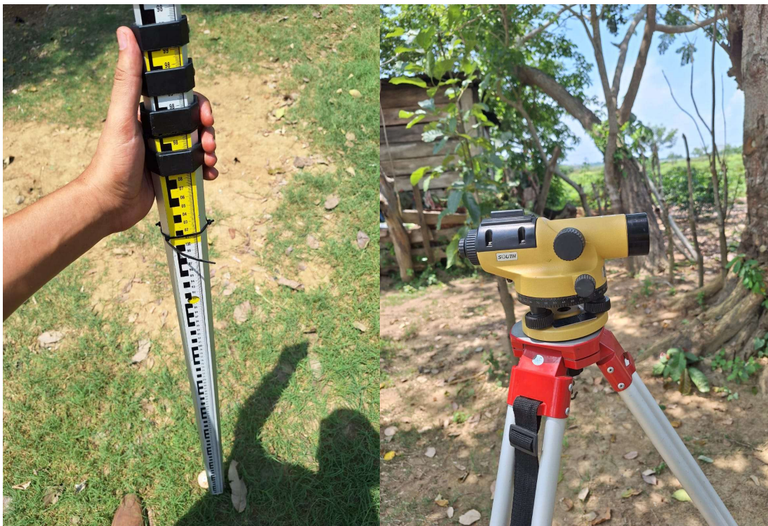
Figura 5. 5 Estadal y Nivel Óptico South NL-C32
