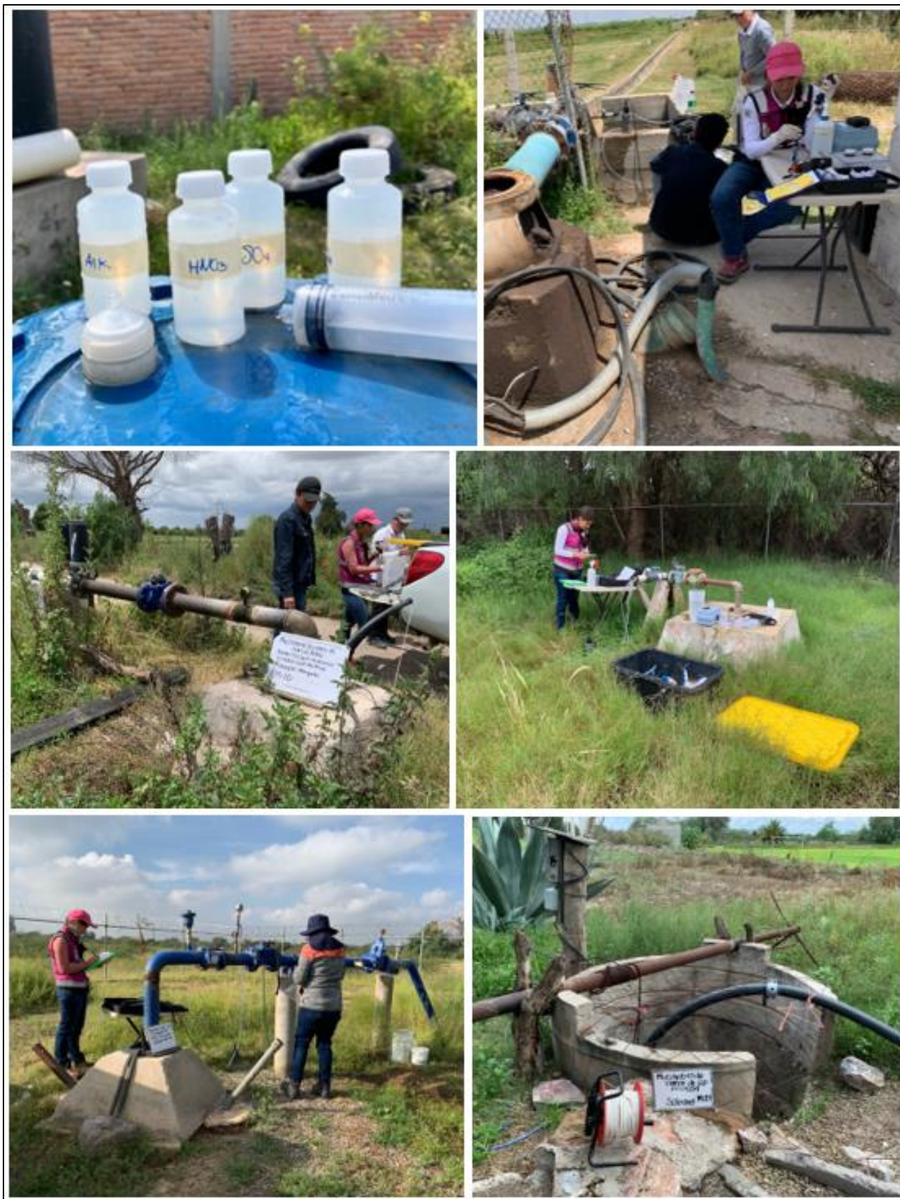
Figura 23. Fotografías de la toma de muestras de agua subterránea.
