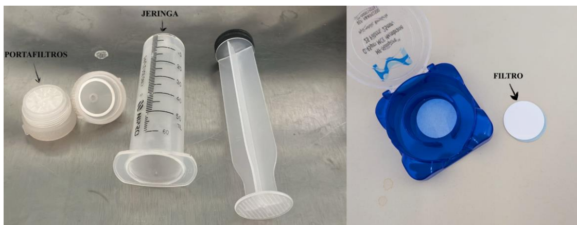
Figura 22. Detalle de la jeringa y portafiltro utilizados en el filtrado de la muestra de agua.
