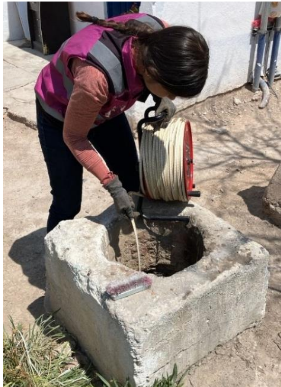
Figura 57. Medición de nivel, con sonda de nivel para pozo convencional.
