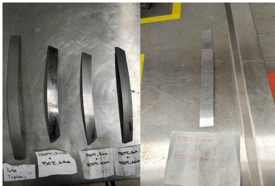
Figura 19. Piezas obtenidas después de la laminación en frío. De izquierda a derecha: ruta típica, 950°C-60 min, 1000°C-60 min, 1050°C-60 min y 1100°C-60 min.
