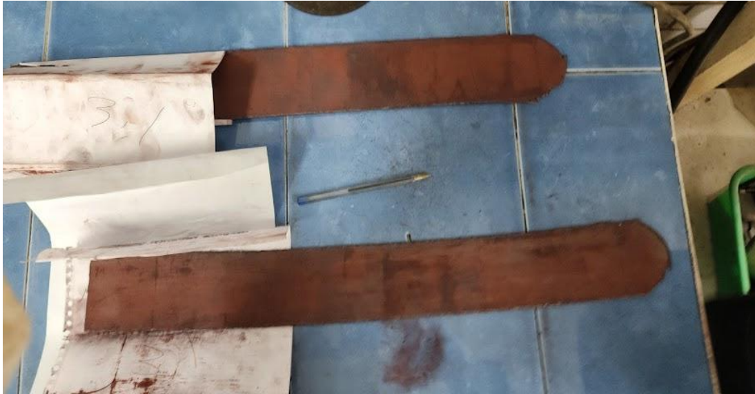
Figura 12. Material obtenido después de la laminación en caliente (espesor 2.3 mm).
