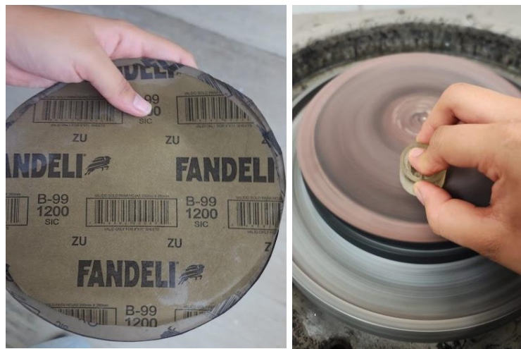
Figura 24. Lijas de carburo de silicio y pasta de diamante empleadas para la preparación metalográfica de las muestras.
