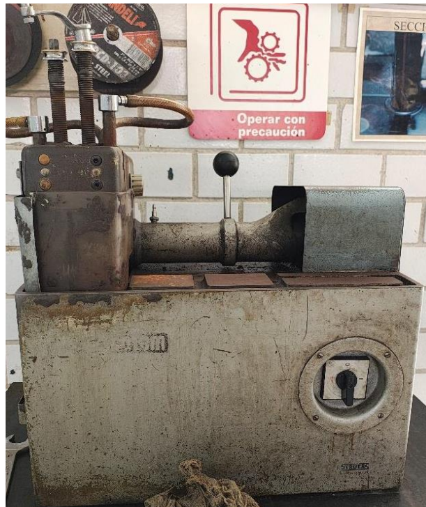
Figura 13. Cortadora de disco de alta velocidad empleada para cortar el material laminado en caliente.
