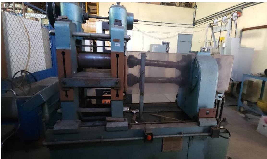
Figura 10. Molino reversible Hille Helicon MK4, empleado para la laminación en caliente.
