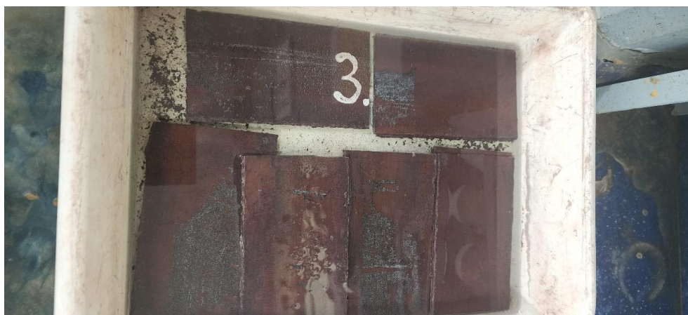
Figura 15. Decapado de muestras empleando una solución de HCl al 10%.
