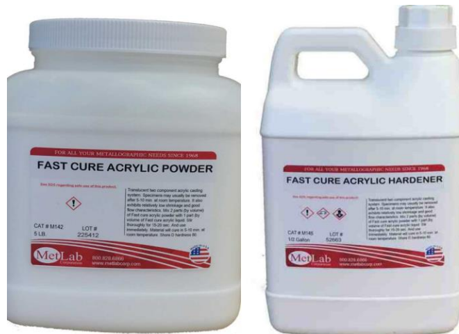
Figura 23. Polvo y endurecedor empleados para el montaje en frío.
