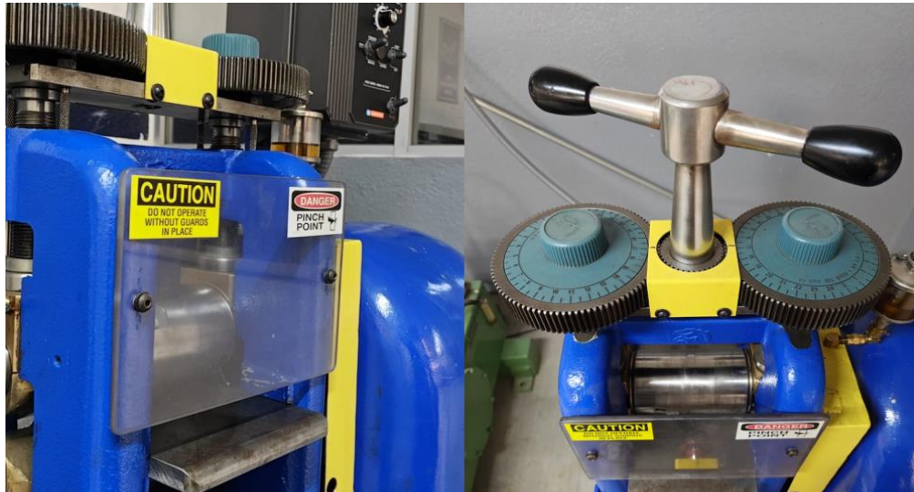
Figura 18. Molino IRM 3350 empleado para las pruebas de laminación en frío.
