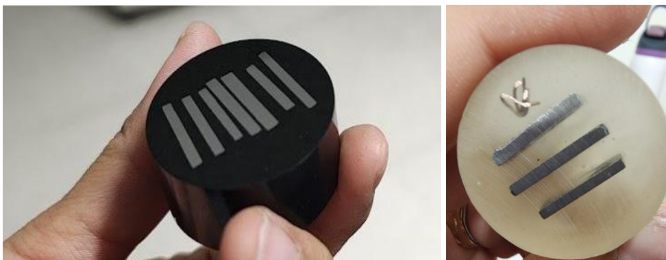
Figura 22. Montaje de muestras para su observación y análisis mediante técnicas de microscopía.
