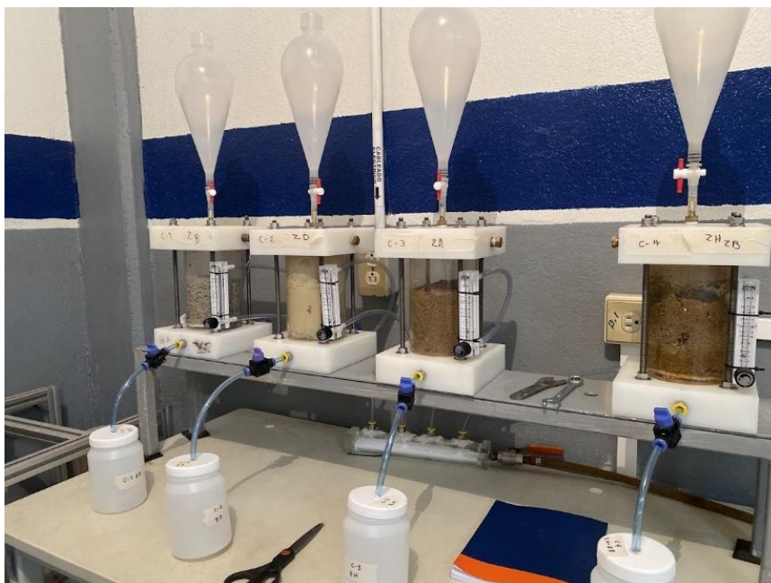
Figura 24. Operación de las celdas húmedas mientras drenan el lixiviado para las mediciones posteriores.
