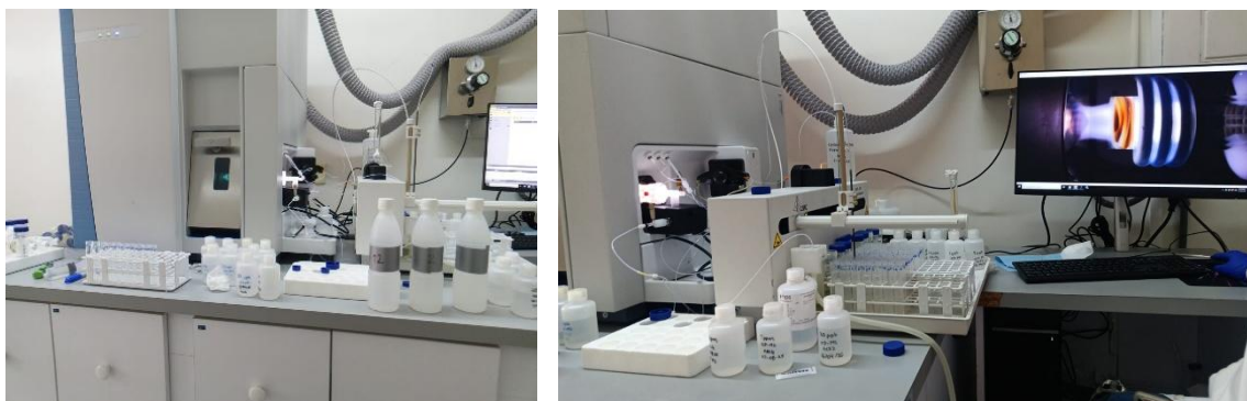
Figura 26. Análisis mediante espectrometría de masas con plasma acoplado inductivamente (ICP- MS).
