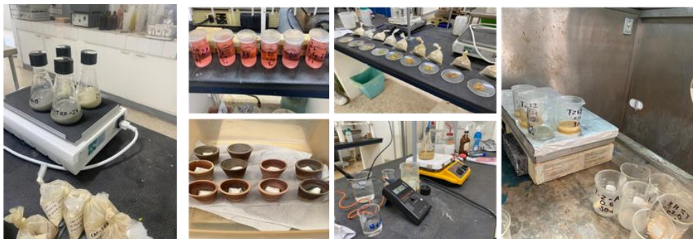
Figura 22. Determinación de PA y PN en pruebas estáticas en el Laboratorio Químico del Instituto de Metalurgia UASLP.
