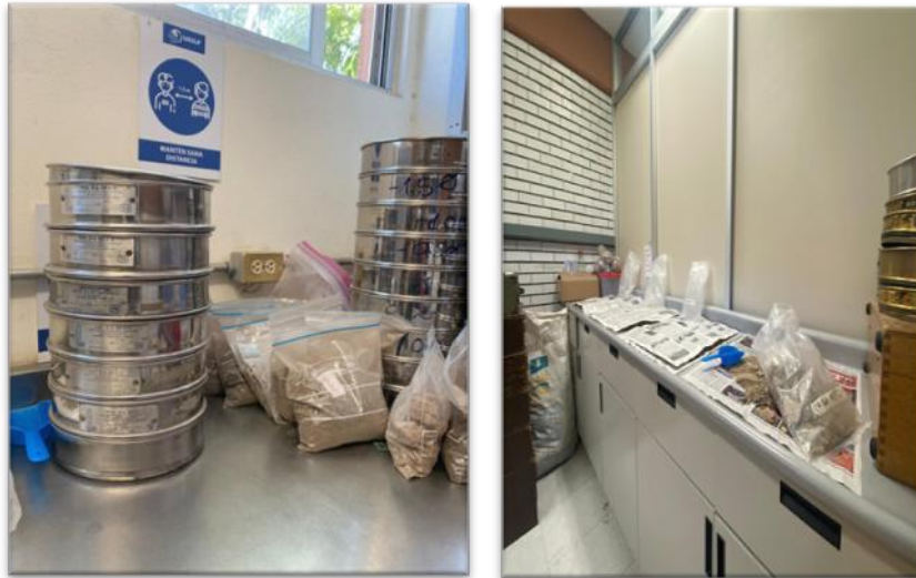
Figura 15. Secado de muestras a temperatura ambiente para pruebas granulométricas
