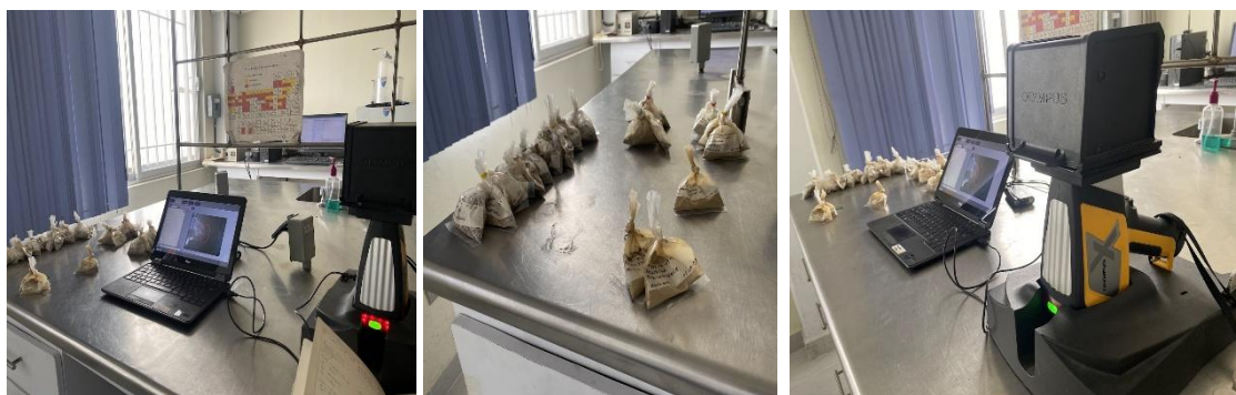
Figura 19. Análisis por fluorescencia de Rayos X en el laboratorio de remediación ambiental del Instituto de Metalurgia UASLP.
