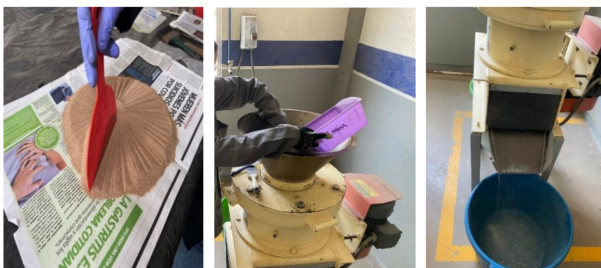
Figura 17. Actividades de homogenización y trituración de material grueso para su posterior molienda.
