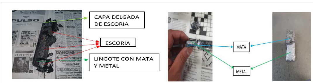
Figura 25. Fundición 14, fases obtenidas metal, mata y escoria.
