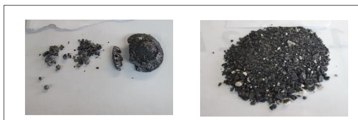
Figura 14. Fundición 7 izda. a dcha. Metal (20.82 g) y mata (73.21 g).
