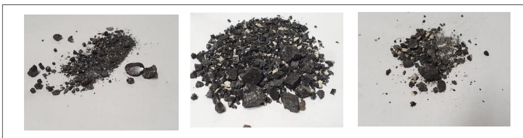
Figura 8. Fundición 1 izda. a dcha. Metal (10.3 g), mata (66.3 g) y escoria (6.3 g).
