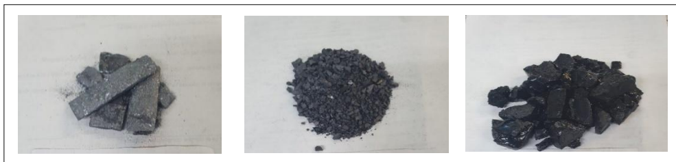
Figura 22. Fundición 13. izda. a dcha. Metal (146.54 g), mata (70.58 g) y escoria (282.53 g).
