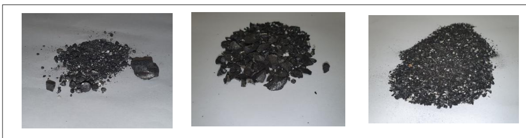
Figura 9. Fundición 2 izda. a dcha. Metal (19.88 g), mata +10 m (54.48 g) y mata -10 m (20.81 g).
