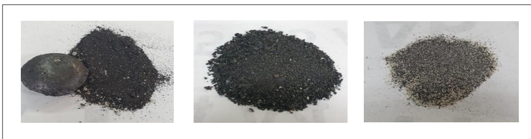
Figura 19. Fundición 12, izda. a dcha. Metal (19.21 g), mata (63.29 g) y metal-escoria-crisol (19.85 g).
