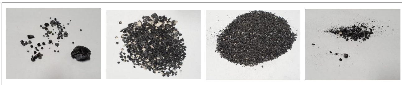
Figura 11. Fundición 4 izda. a dcha. Metal (8.59 g), mata +10 m (21.85 g), mata -10 m (53.92 g) y escoria (1.0 g).
