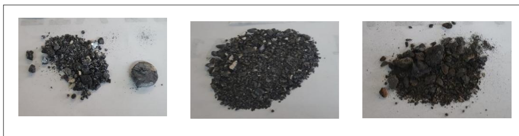
Figura 13. Fundición 6 izda. a dcha. Metal (19.56 g), mata (60.41 g), material sin fundir (4.48 g).
