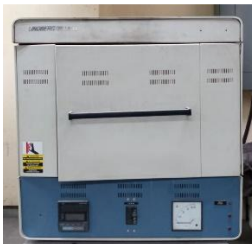
Figura 5. Horno de resistencias de carburo de silicio utilizado en las pruebas de fundición de residuos metalúrgicos.
