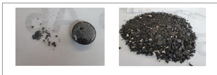
Figura 15. Fundición 8 izda. a dcha. Metal (17.85 g) y mata (72.01 g).
