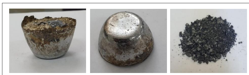
Figura 34. Metal de la fundición 17 refinado (151.60 g) y dross (18.01 g).
