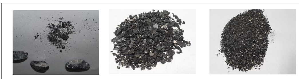
Figura 10. Fundición 3 izda. a dcha. Metal (16.40 g), mata +10 m (46.42 g) y mata -10 m (30.25 g).
