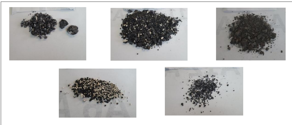
Figura 12. Fundición 5 izda. a dcha. Metal (22.35 g), mata (62.90 g), material sin fundir (4.25 g), escoria con restos de crisol (5.42 g) y metal con escoria (1.45 g).
