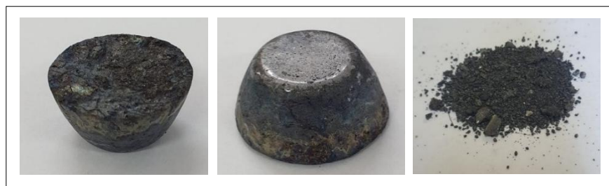
Figura 33. Metal de la fundición 16 refinado (160.97 g) y dross (4.62 g).
