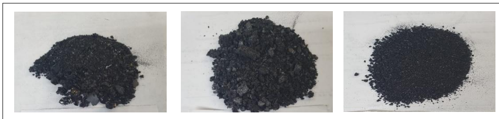
Figura 23. Fundición 13. Escoria con mata (47.37 g), material magnético sin fundir (50.46 g) y material no magnético sin fundir (8.45 g).
